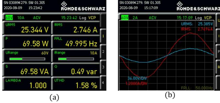
Şekil 85. CCS-MPC ile (a) KGK çıkış gerilimi THD'si, (b) akım ve gerilim dalga biçimi ( C_f = 33\mu F )
