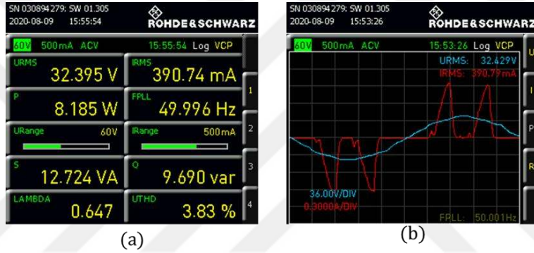
Şekil 86. Doğrusal olmayan yük altında CCS-MPC ile KGK çıkış gerilimi performansı (a) ve yük akımı, çıkış gerilimi dalga biçimi (b), ( \eta=7.8 , V_d^* = 50V , \%THD = 3.83 )
