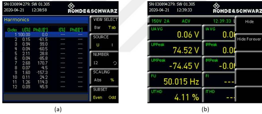
Şekil 76. Doğrusal olmayan yük altına gerilim harmonikleri (a) ve %THD (b)
