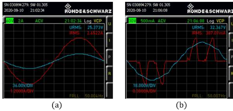
Şekil 88. KGK çıkış gerilimi ve bir faza ait akım (a) doğrusal yük altında, (b) doğrusal olmayan yük altında
