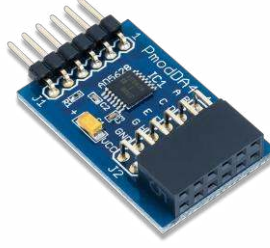
Şekil 2.2 : Pmod DA4 12-Bit Dijital-Analog Dönüştürücü Modülü [117].
