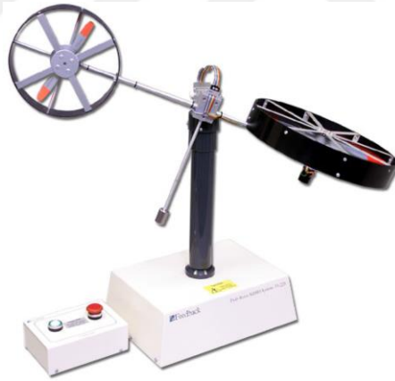
Şekil 4.27. ÇGÇS uçuş sistemine ait deney düzeneği
