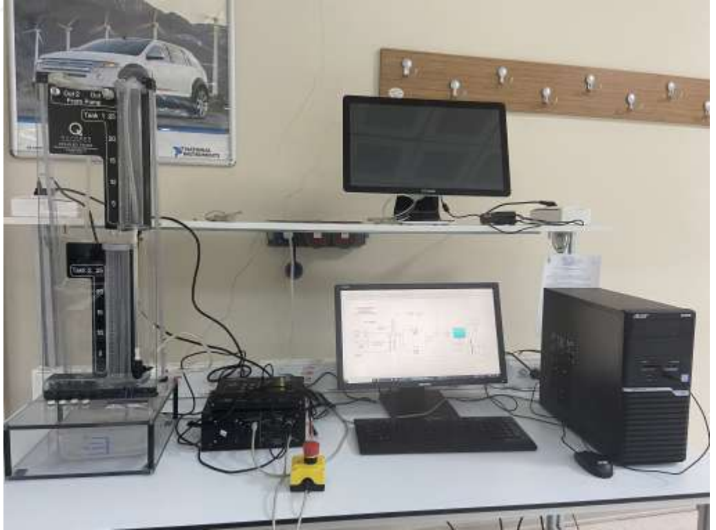
Şekil 4.39. İkili tank sıvı seviye sistemi deney düzeneği
