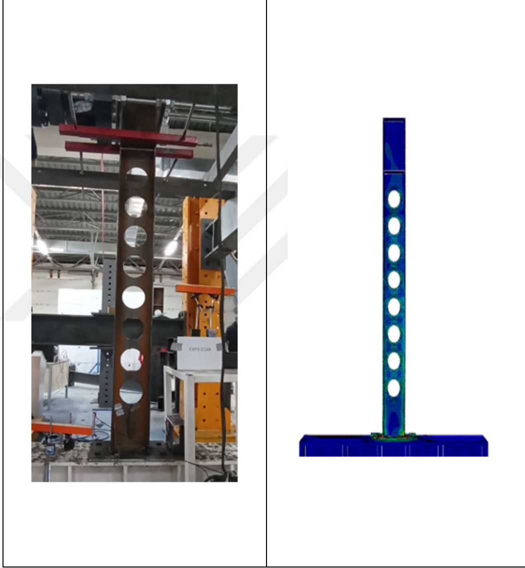
Şekil 4.40. Delik çapı D=148 mm olan kirişde hiçbir göçme modu oluşmamıştır (EXP3-D148).
