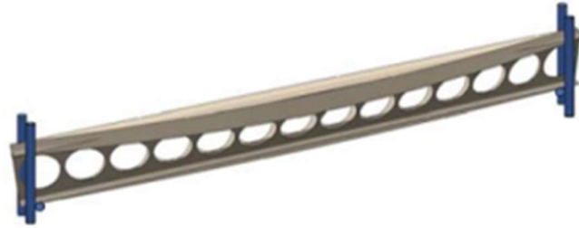
b. Dairesel kirişte yanal burulmalı burkulma (Sonck 2015)
