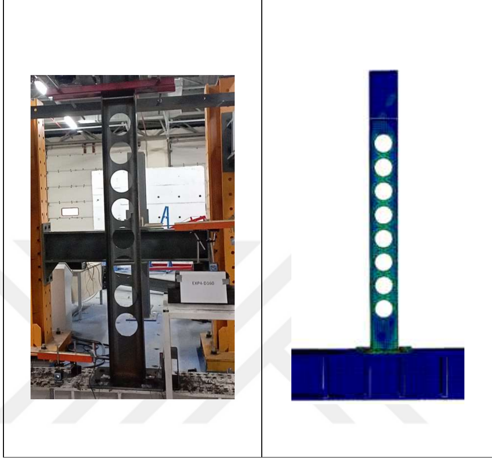
Şekil 4.43. Delik çapı D=160 mm olan kirişde hiçbir göçme modu oluşmamıştır (EXP4-D160).
