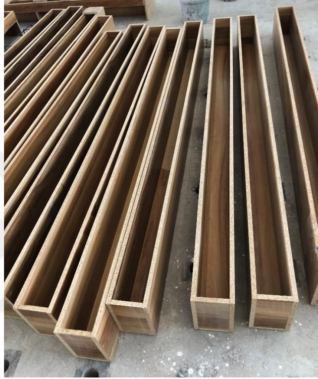
Şekil 3.11. Kiriş numunelerin hazır kalıpları
