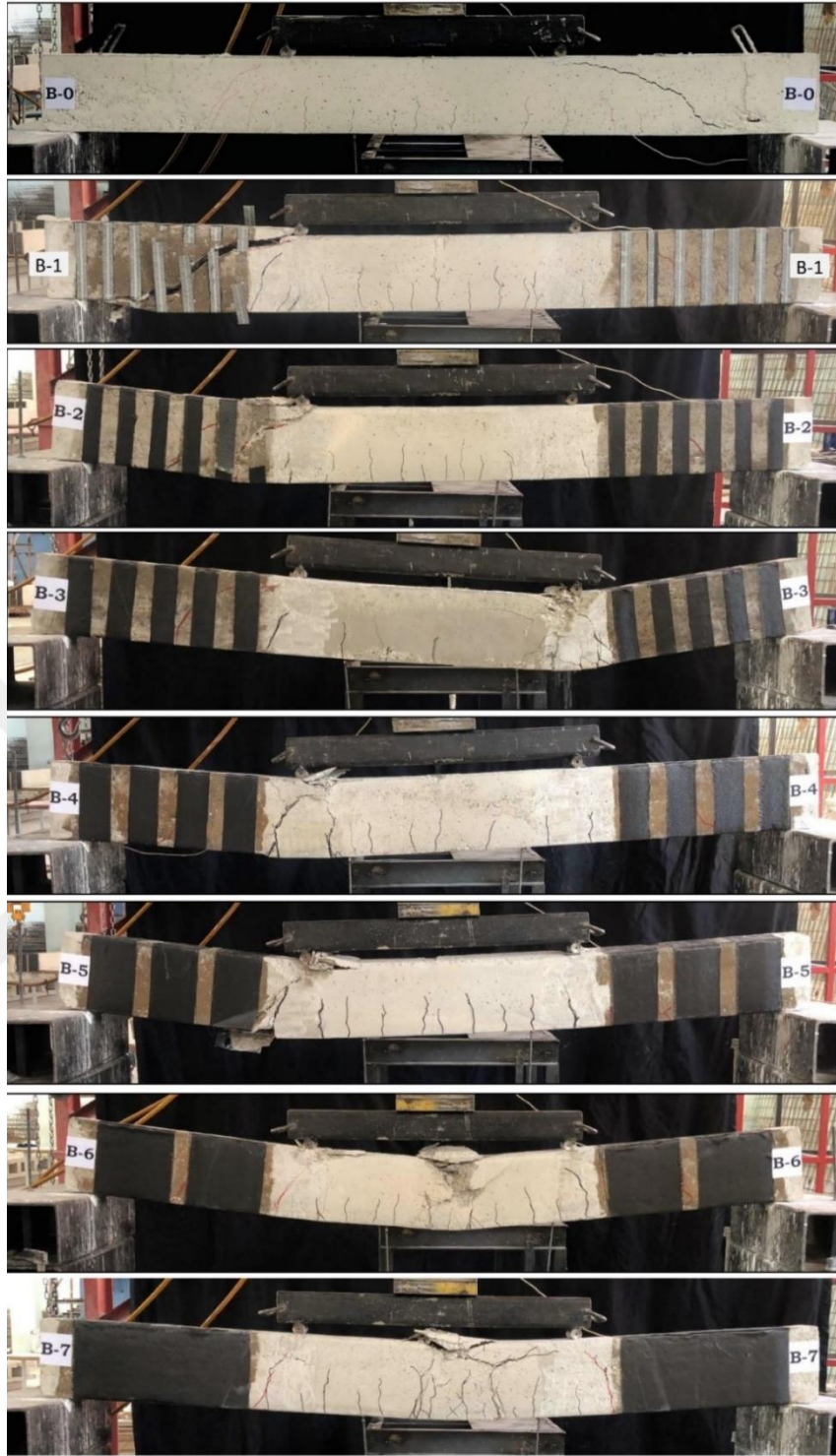
Şekil 4.24. Tüm numunelerin deney sonu hasar görünümü
