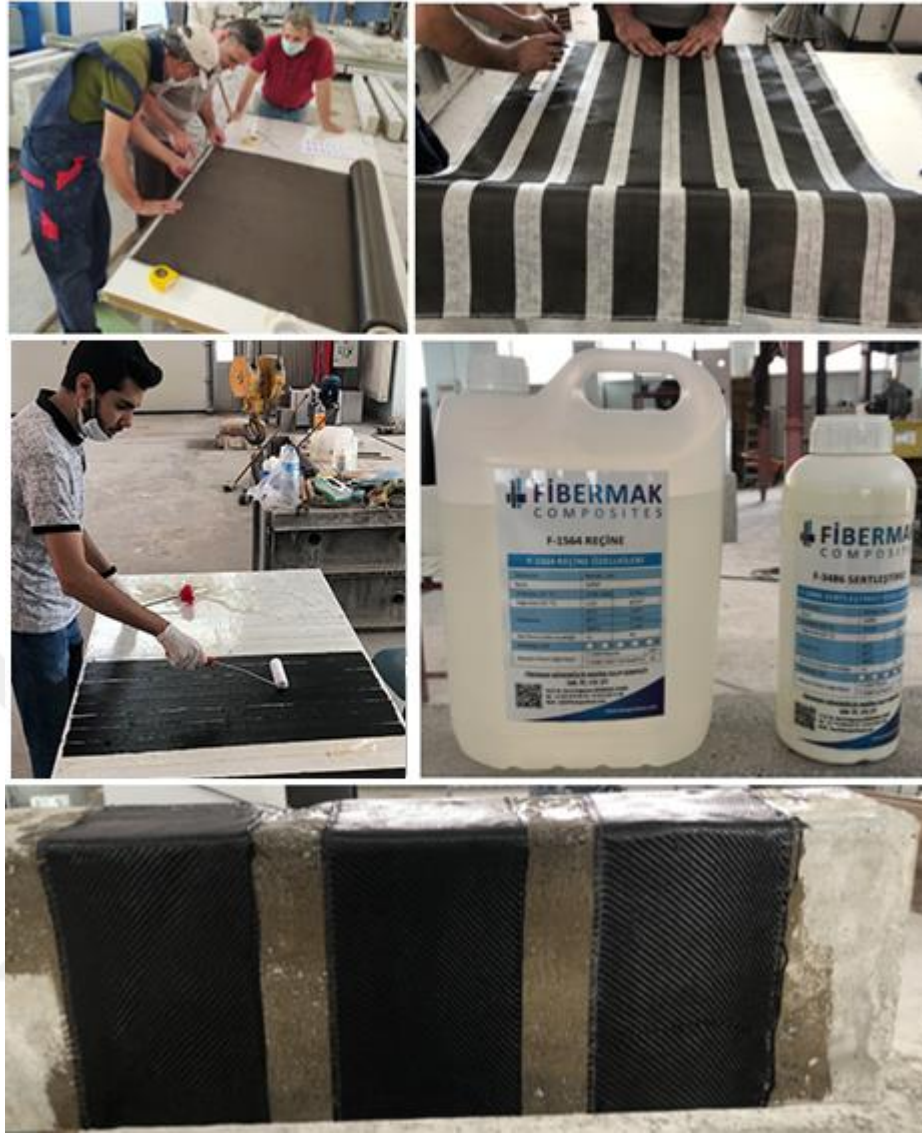
Şekil 3.10. Kiriş numunelere CFRP şeritlerini uygulama aşaması
