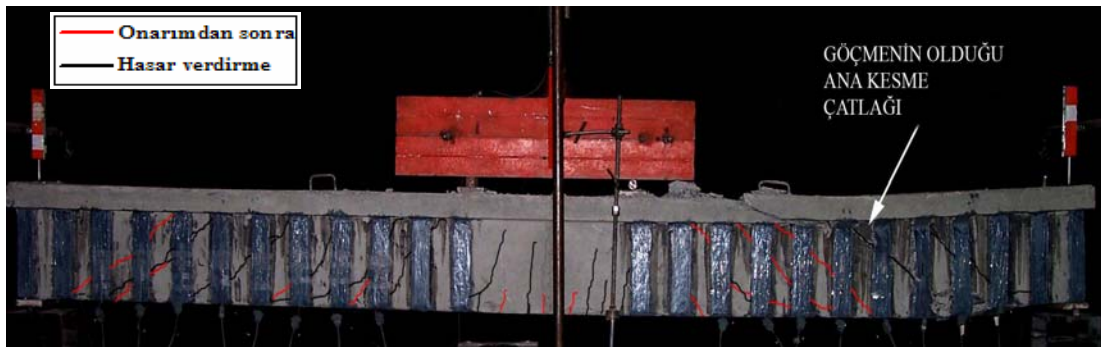
Resim 4.7. Göçmeden sonra, deney elemanı 3
