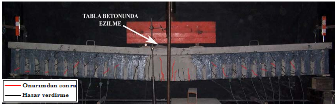
Resim 4.13. Göçmeden sonra, deney elemanı 5
