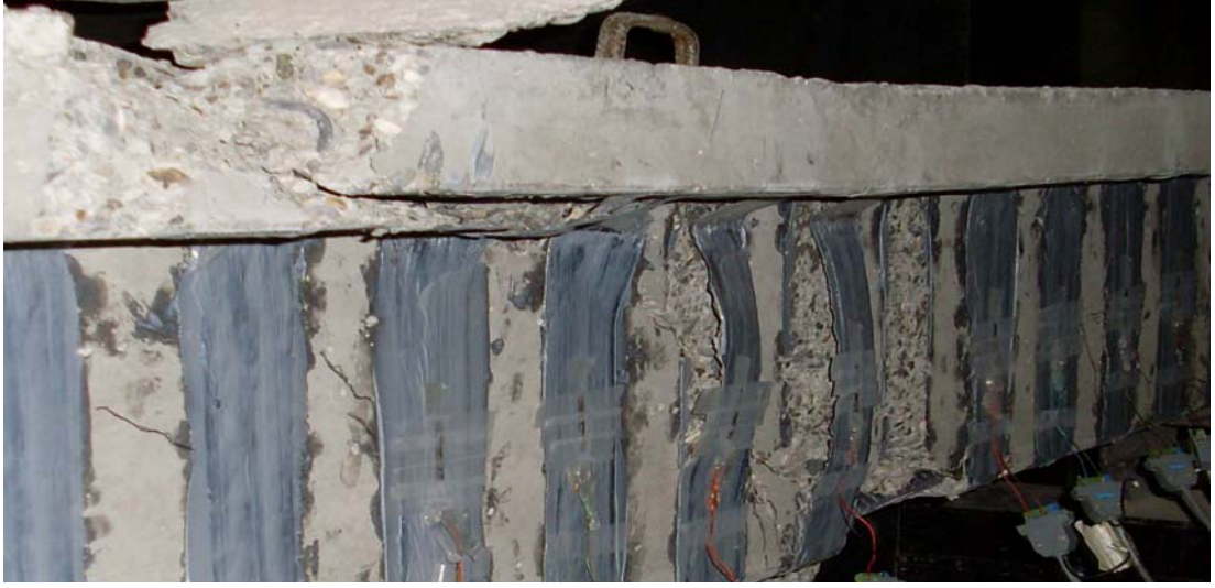
Resim 4.4. Göçmeden sonra CFRP şeritte soyulma detayı, deney elemanı 2
