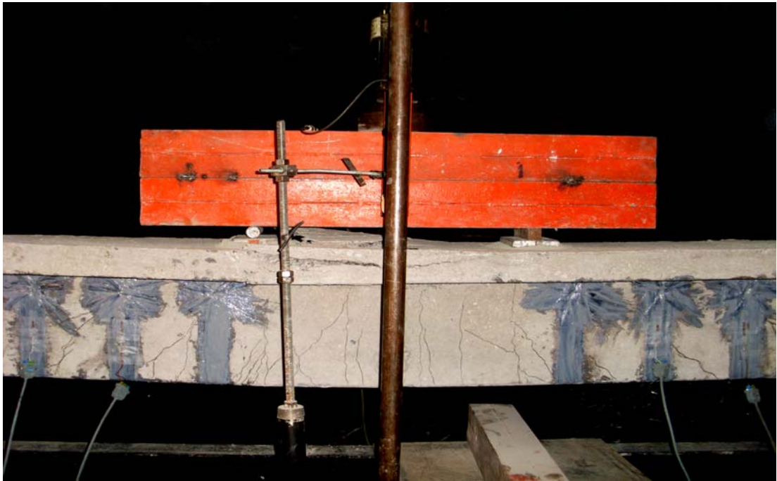
Resim 4.18. Tabla betonunda ezilme, deney elemanı 7
