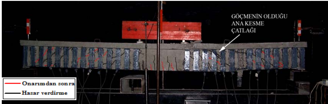
Resim 4.3. Göçmeden sonra, deney elemanı 2
