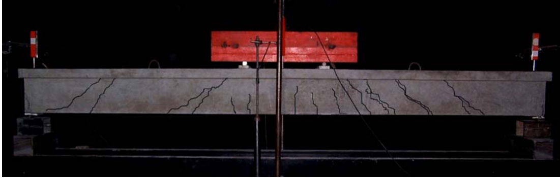
Resim 4.2. Hasar verdirme deneyi, deney elemanı 2
