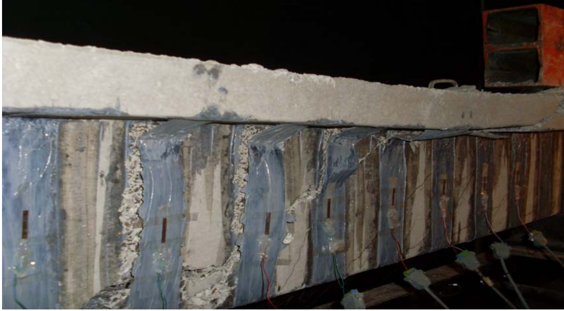
Resim 4.6. Göçmeden sonra CFRP şeritte soyulma detayı, deney elemanı 3
