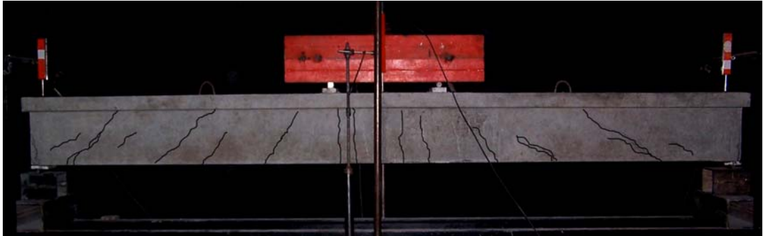
Resim 4.11. Hasar verdirme deneyi, deney elemanı 5
