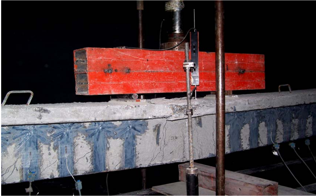
Resim 4.15. Tabla betonunda ezilme, deney elemanı 6
