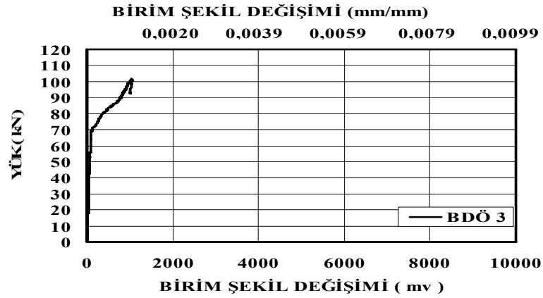
Şekil 4.3. Yük-Birim deformasyon grafikleri, deney elemanı 2
