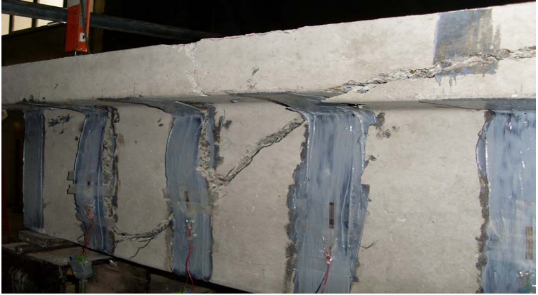
Resim 4.9. Göçmeden sonra CFRP şeritte soyulma detayı, deney elemanı 4
