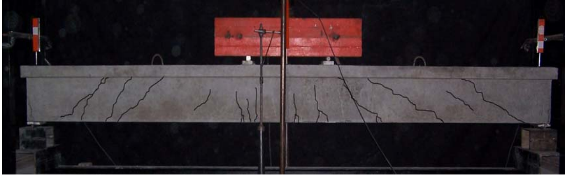
Resim 4.5. Hasar verme deneyi, deney elemanı 3
