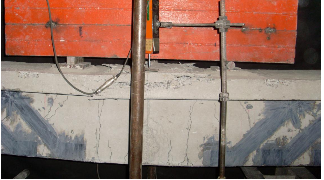
Resim 4.22. Beton basınç bölgesinin ezilmesi, deney elemanı 7
