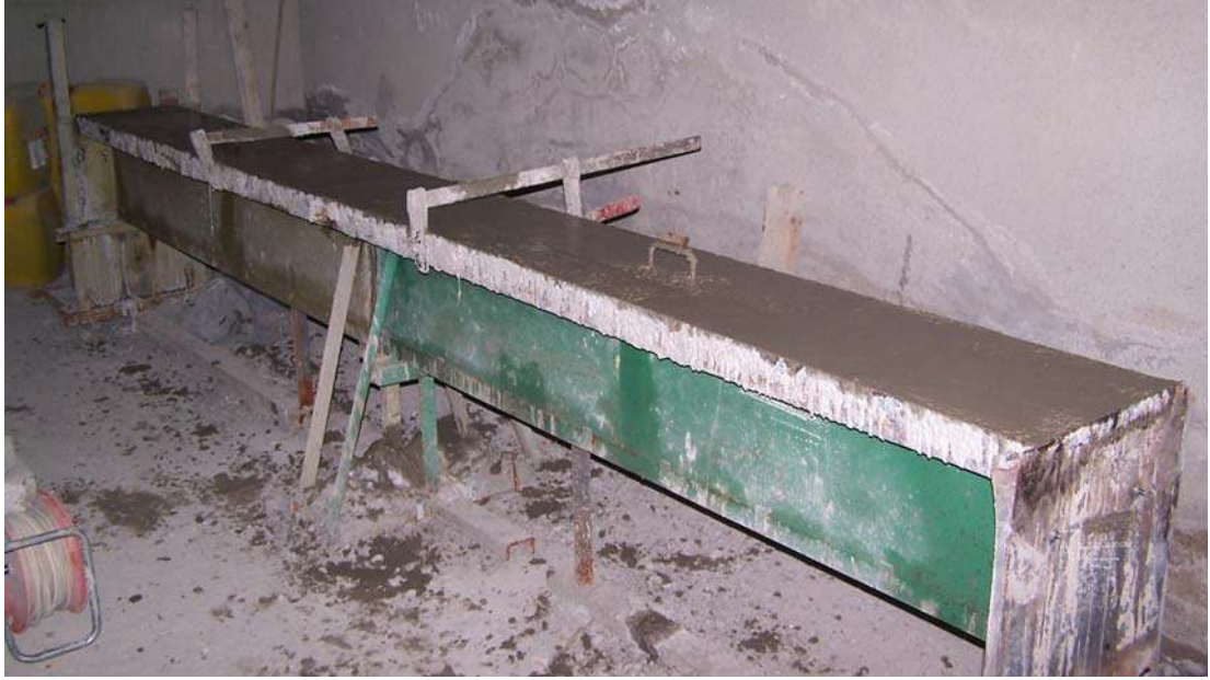
Resim 2.1. Beton dökümü tamamlanmış deney elemanı
