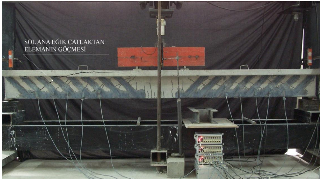
Resim 4.11. Göçme sonrası, deney elemanı 4
