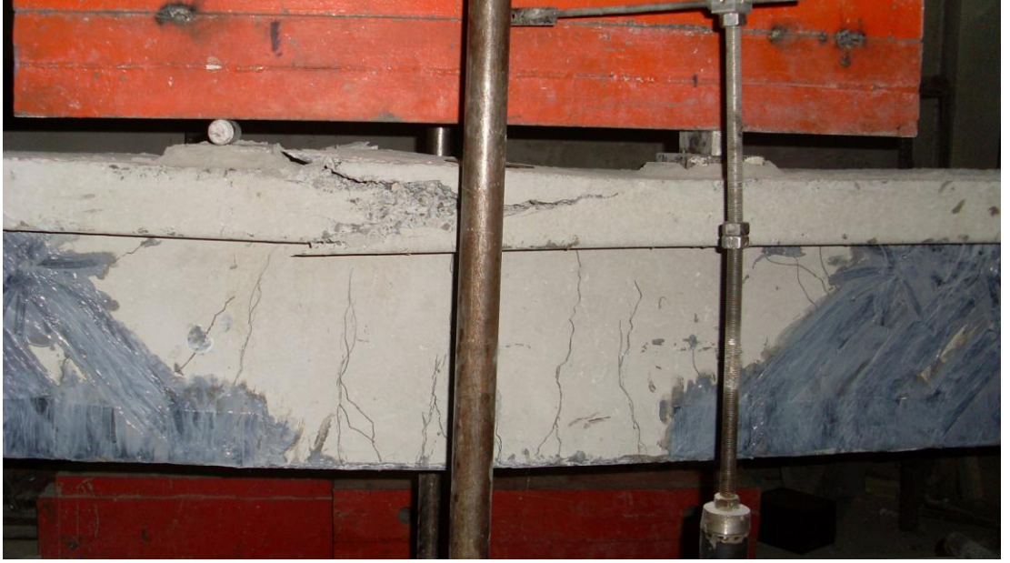
Resim 4.16. Beton basınç bölgesinin ezilmesi, deney elemanı 5
