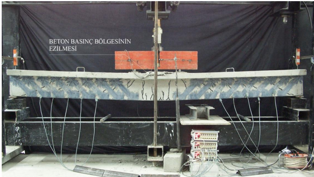
Resim 4.21. Göçme sonrası, deney elemanı 7
