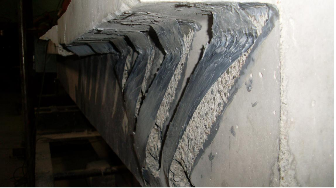
Resim 4.9. CFRP şeritlerde soyulma, deney elemanı 3
