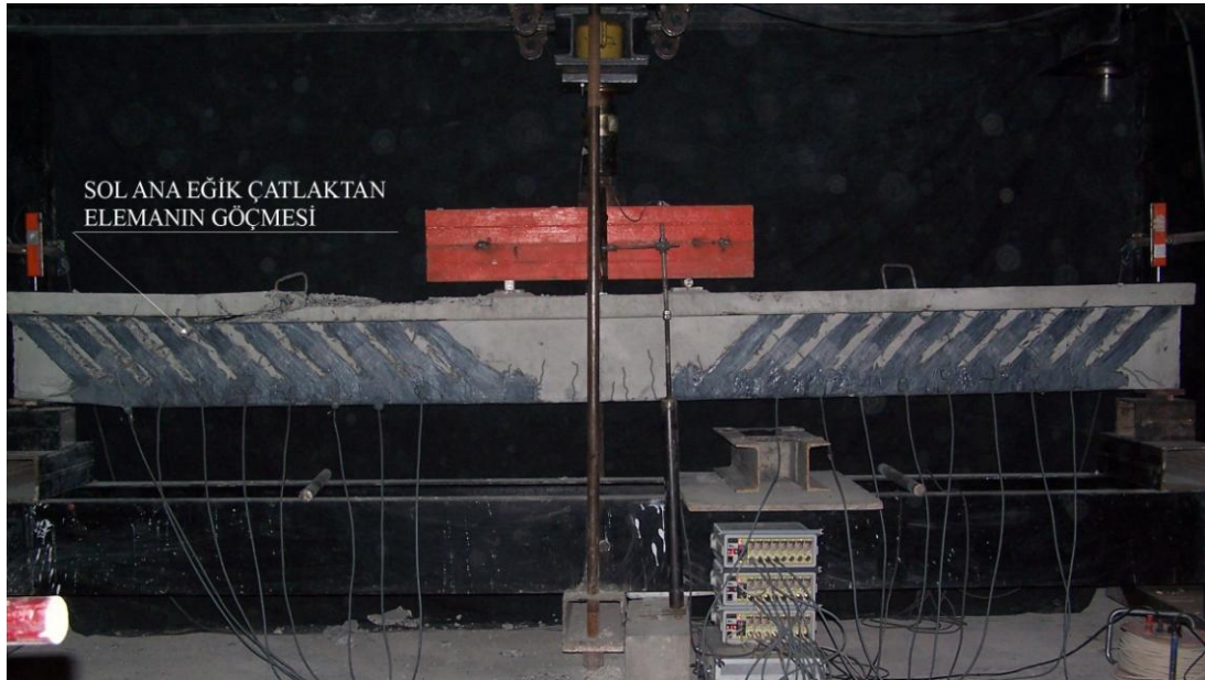
Resim 4.7. Göçmeden sonra, deney elemanı 3
