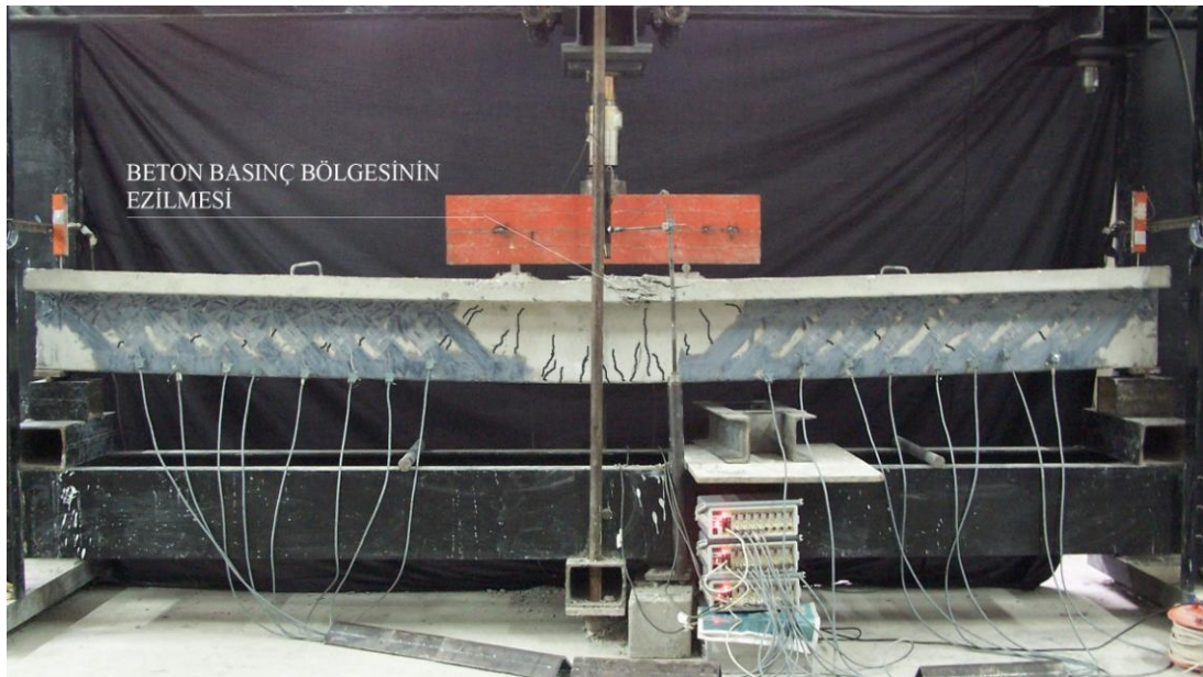
Resim 4.18. Göçme sonrası, deney elemanı 6
