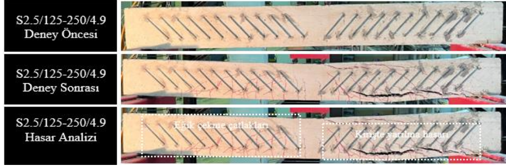
Şekil 4.27. S2.5/125-250/4.9 kirişine ait göçme sonrası hasar detayları ( a_v/d=4.9 )
