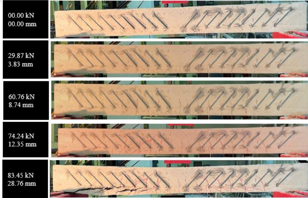
Şekil 4.22. S2.0/125-250/4.9 kirişinde deney aşamasında oluşan hasarlar ( a_v/d=4.9 )
