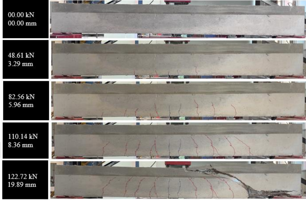
Şekil 4.34. N0.0/125-360/3.3 referans kirişinde deney aşamasında oluşan hasarlar a_v/d=3.3 )
