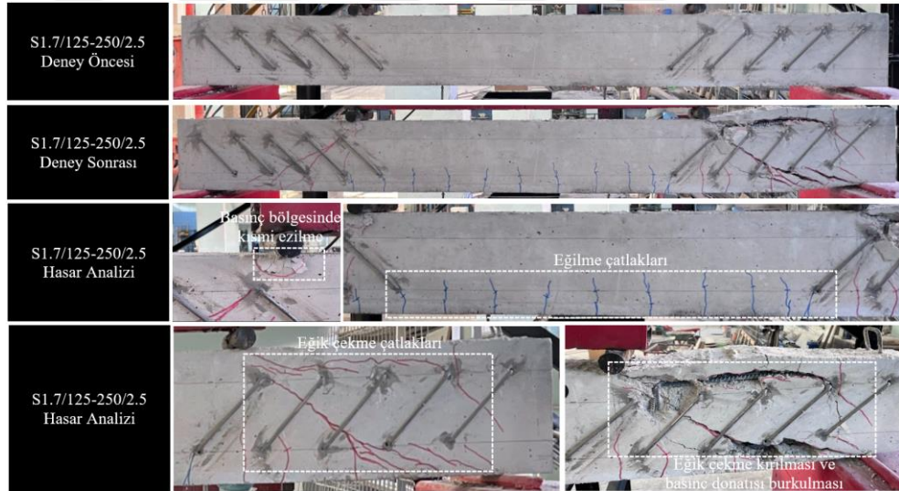
Şekil 4.6. S1.7/125-250/2.5 deney kirişine ait göçme sonrası hasar detayları ( a_v/d=2.5 )
