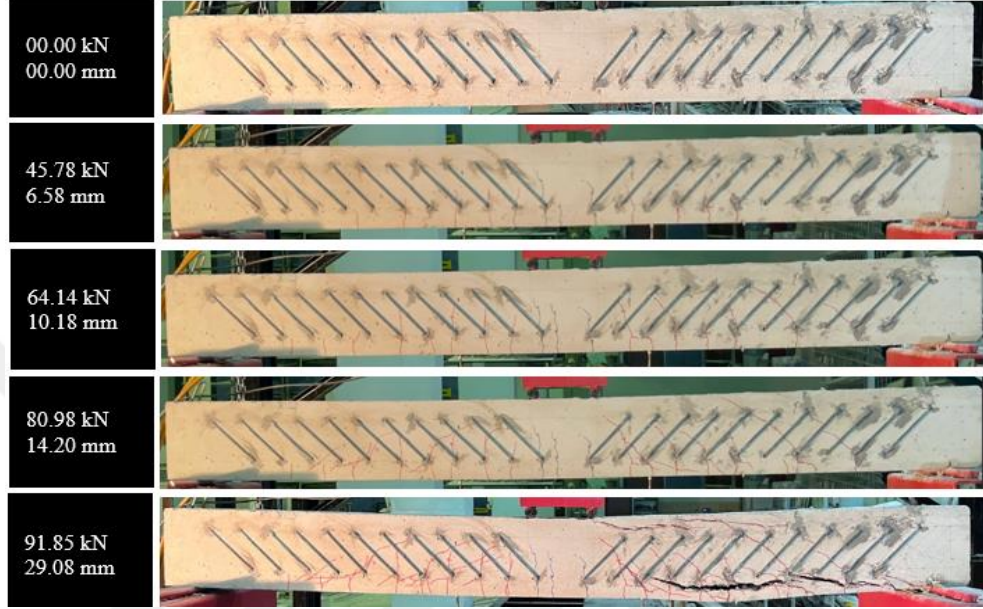
Şekil 4.25. S2.5/125-250/4.9 kirişinde deney aşamasında oluşan hasarlar ( a_v/d=4.9 )
