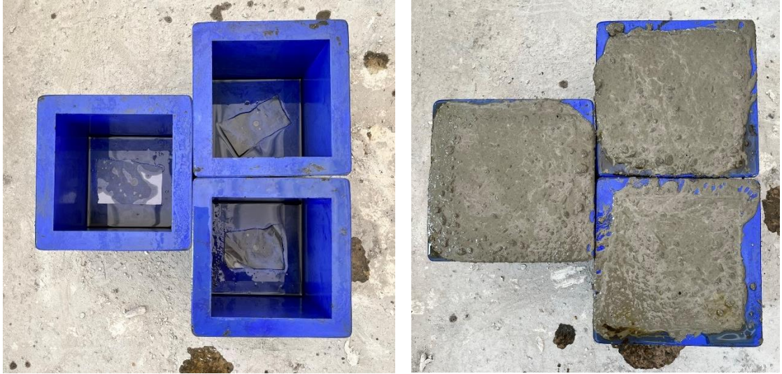
Şekil 3.10. Küp kalıplarının yağlanması ve betonun dökülmesi
