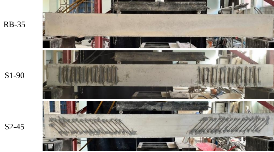
Şekil 2.14. Mekanik dikiş ile güçlendirilmiş kirişler (Uysal ve ark. 2022)
