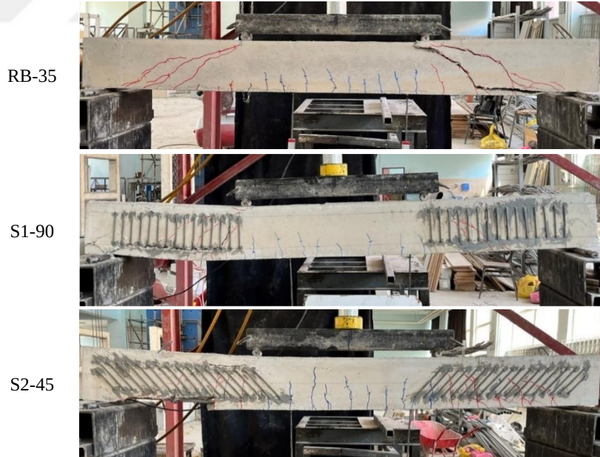
Şekil 2.15. Mekanik dikiş uygulamasının kesme kapasitesine katkısı (Uysal ve ark. 2022)
