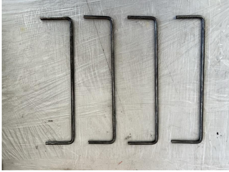
Şekil 3.14. Mekanik dikişlerin U şeklinde bükülmesi
