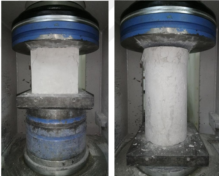
Şekil 3.12. K p ve silindir numunelerinin kırım aşaması
