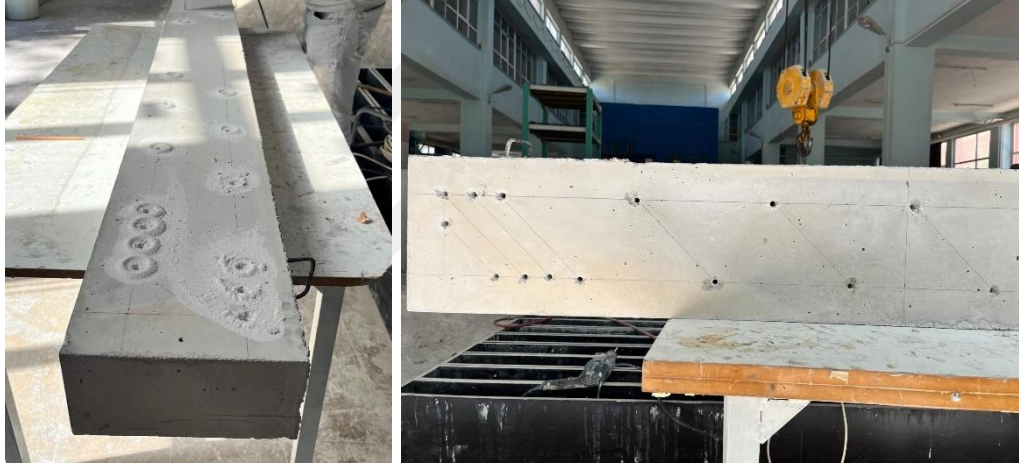
Şekil 3.15. Ankraj deliklerinin açılması ve temizlenmesi
