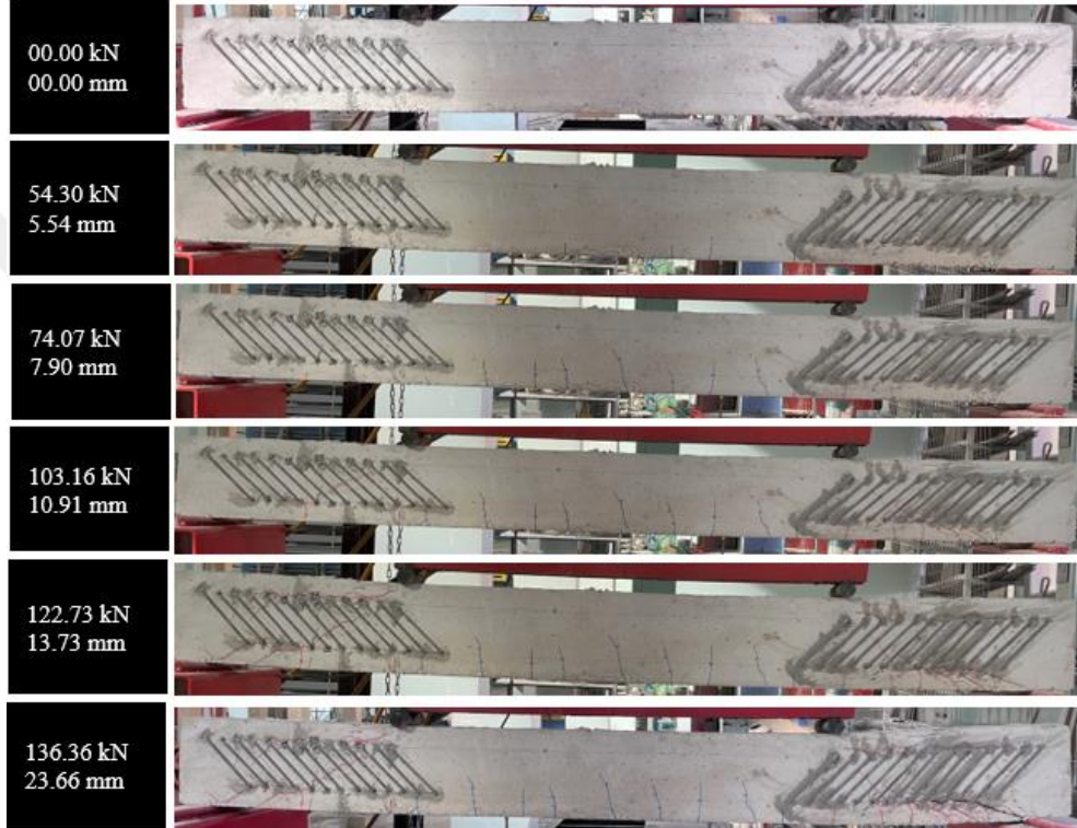
Şekil 4.16. 5.0/125-250/2.5 kirişinde deney aşamasında oluşan hasarlar ( a_v/d=2.5 )
