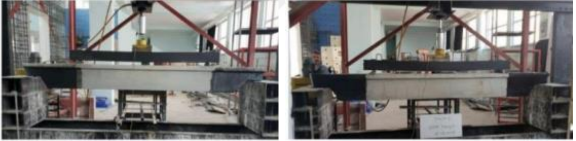
Şekil 2.3. CFRP ile kesme bölgesi güçlendirilen aşık kirişleri ve deney düzeneği (Aksoylu ve ark., 2019)
