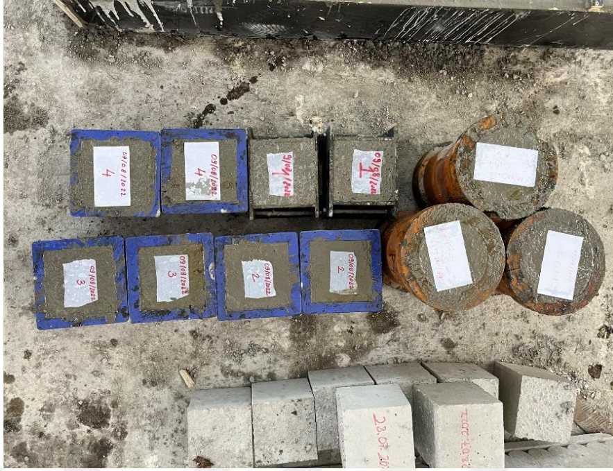
Şekil 3.11. K p ve silindir numuneleri
