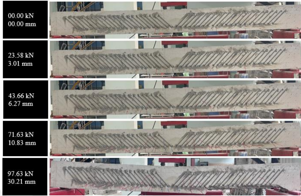
Şekil 4.31 S5.0/125-250/4.9 kirişinde aşamasında oluşan hasarlar ( a_v/d=4.9 )
