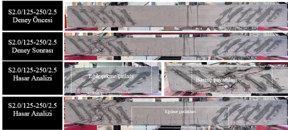
Şekil 4.9. S2.0/125-250/2.5 kirişine ait göçme sonrası hasar detayları ( a_v/d=2.5 )
