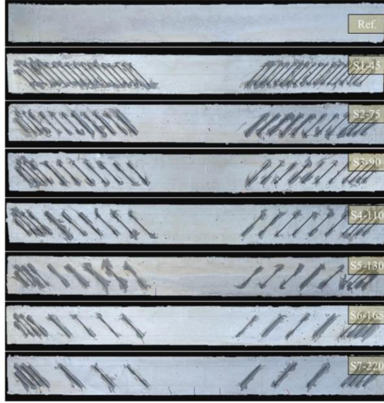
Şekil 2.17. MÇD ile güçlendirilmiş kiriş numuneleri (Aksoylu ve ark., 2023)
