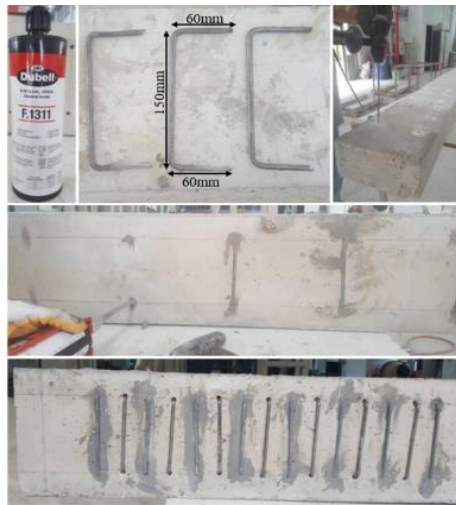
Şekil 2.12. MÇD uygulama aşamaları (Aksoylu ve ark., 2022)
