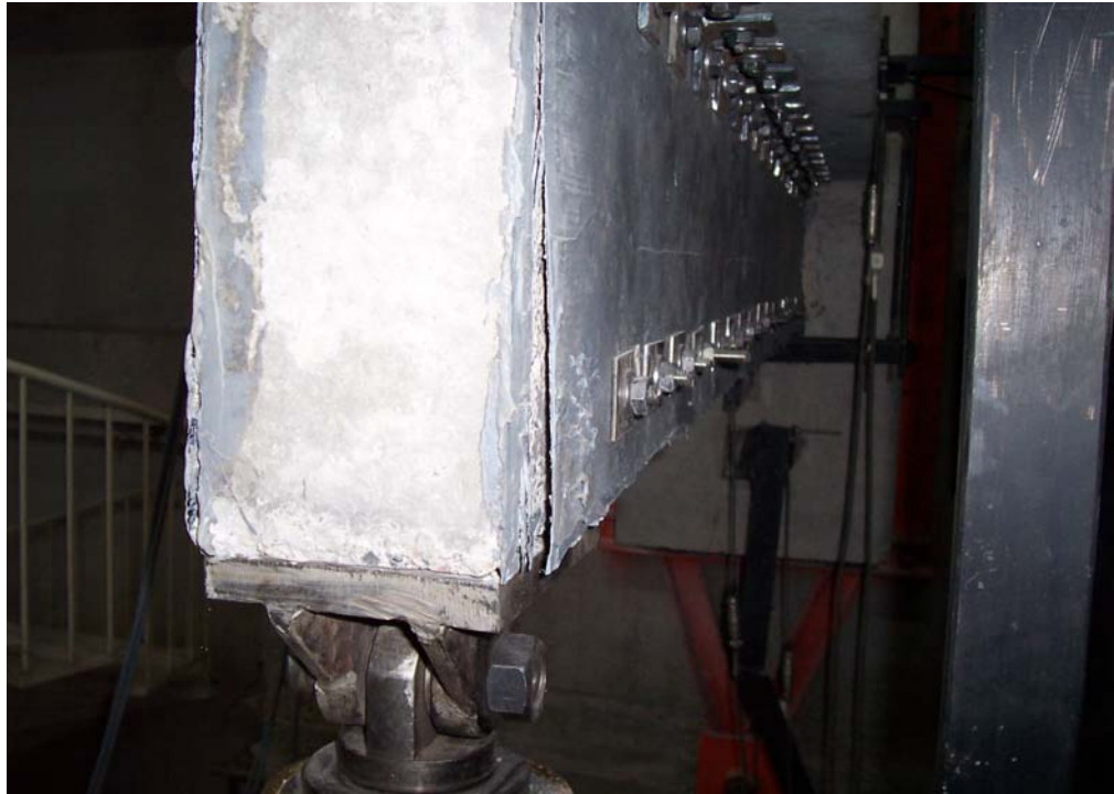
Şekil 3.15 Deney elemanı 3'ün yükleme ucunda oluşan dokumanın beton yüzeyinden ayrılmasına ait fotoğraf
