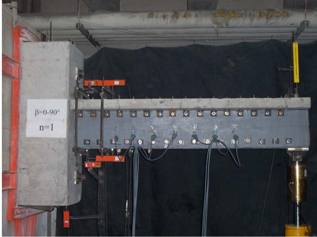
Şekil 3.20 Deney elemanı 4'ün 1. ileri çevrim sonrası görünümü
