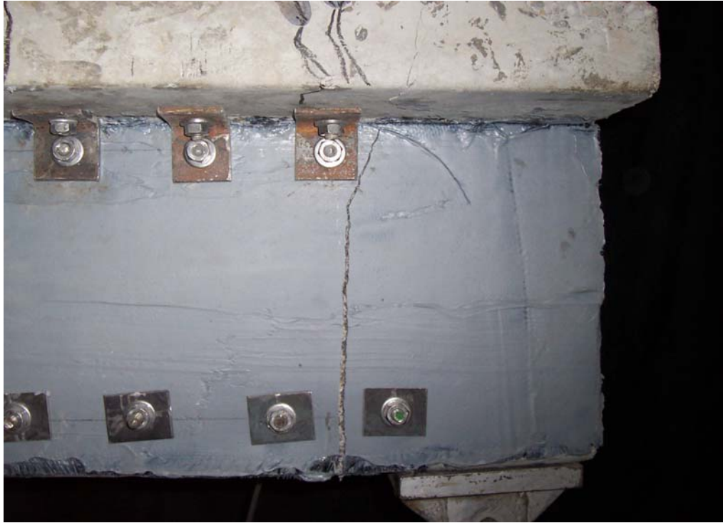
Şekil 3.33 Deney elemanı 6'nın yükleme ucunda görülen dokumanın kopması
