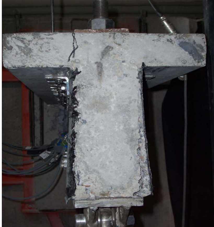
Şekil 3.27 Deney elemanı 5'in yükleme ucunda fiber dokumada oluşan ayrılma
