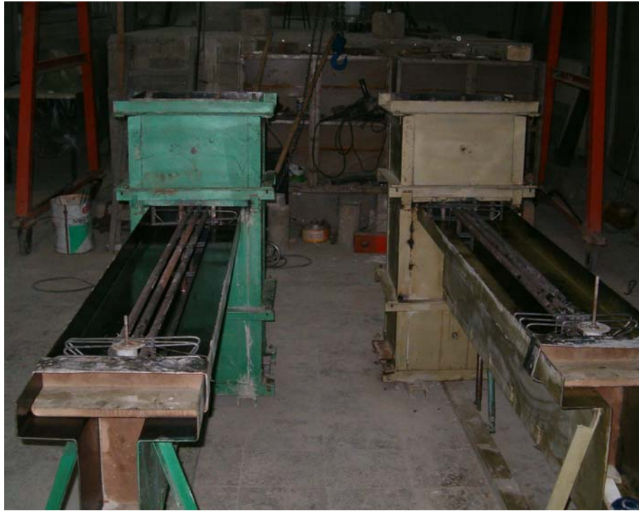
Şekil 2.3 Kalıp içerisinde görülen donatı resmi
