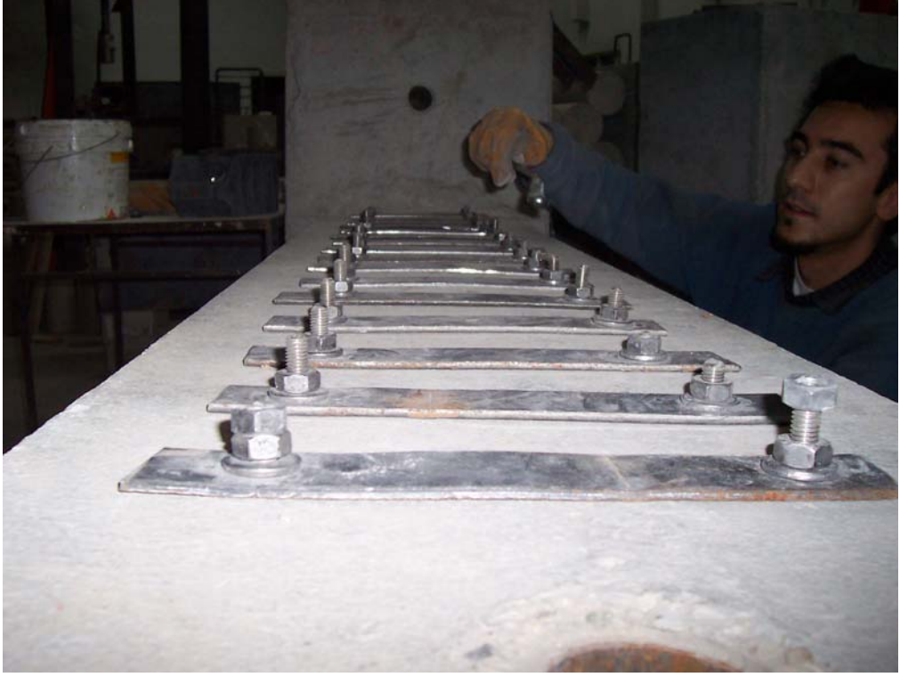
Şekil 2.7 Mekanik ankraj uygulaması
