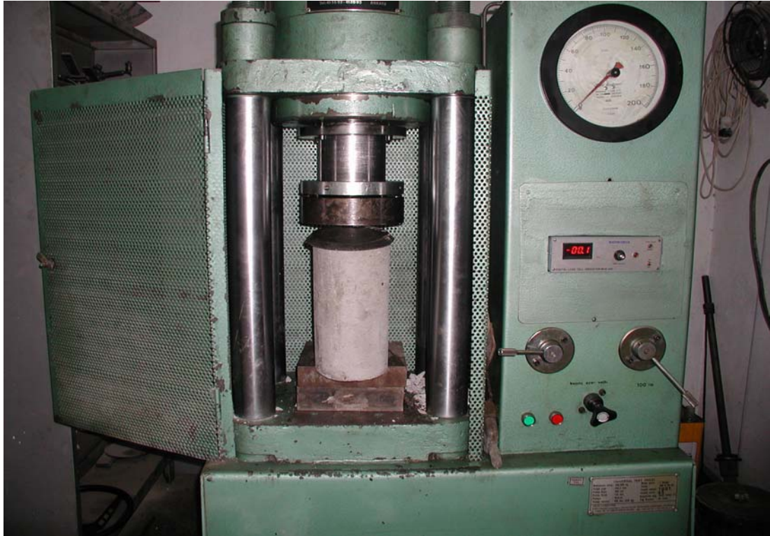
Şekil 2.6 Beton silindir deneyi
