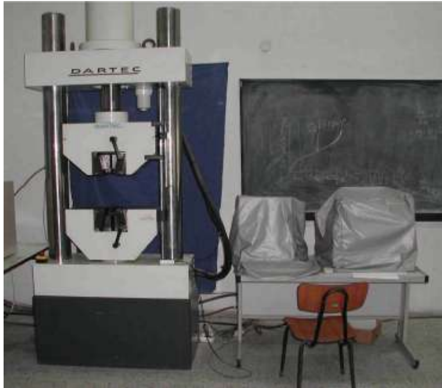
Şekil Ek-A1 Çekme deneyinde kullanılan deney düzeneği
