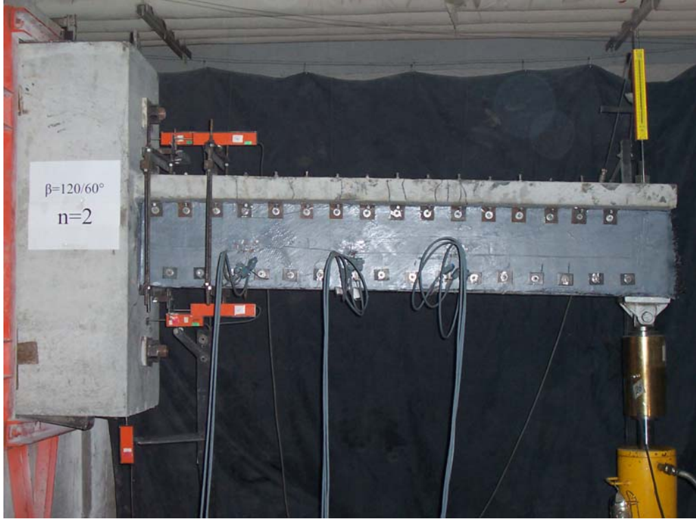
Şekil 3.26 Deney elemanı 5'in 10. geri çevrim sonundaki görünüşü
