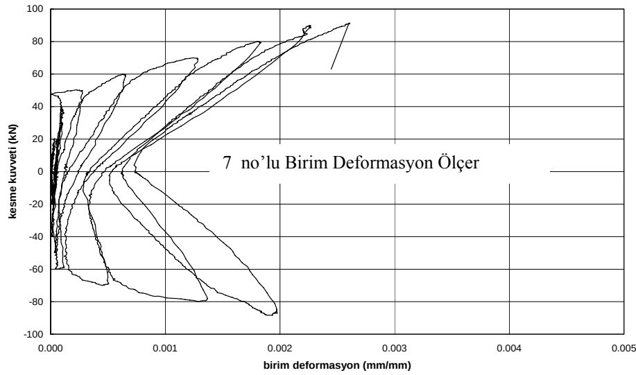
Şekil 3.13 Deney elemanı 3'e ait kesme kuvveti-birim deformasyon grafikleri
