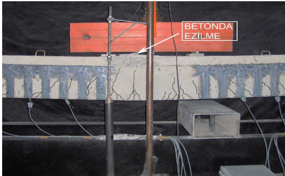
Resim 4.8. Tabla betonunda ezilme, Deney elemanı 5
