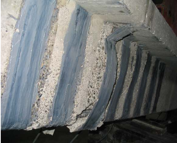
Resim 4.2. CFRP şeridin kiriş yüzeyinden soyulması
