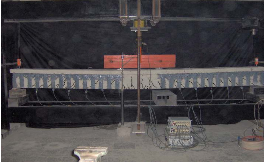
Resim 4.9. Göçmeden sonra, deney elemanı 5
