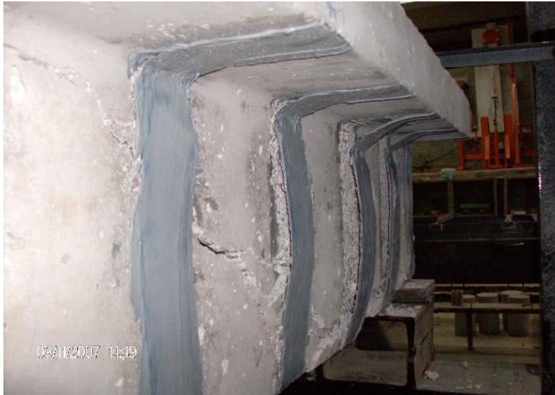
Resim 4.6. CFRP řeritlerinin kiriř yzeyinden soyulması
