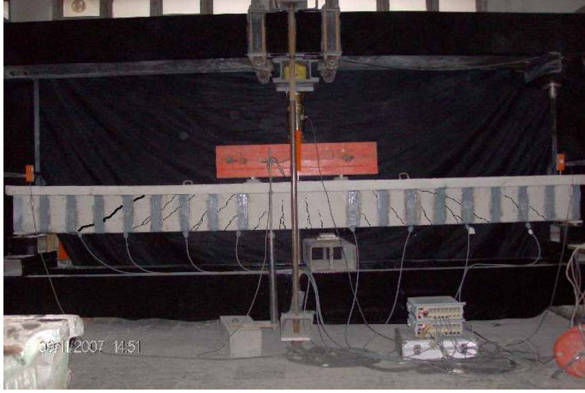
Resim 4.7. Göçmeden sonra, deney elemanı
