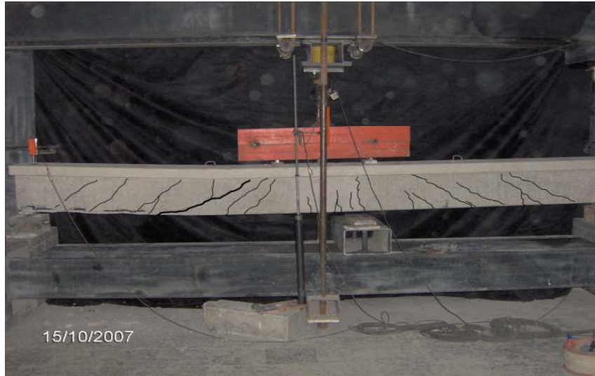
Resim 4.1. Göçmeden sonra, deney elemanı 1
