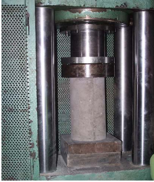
Resim 2.2. Standart silindir numune testi
