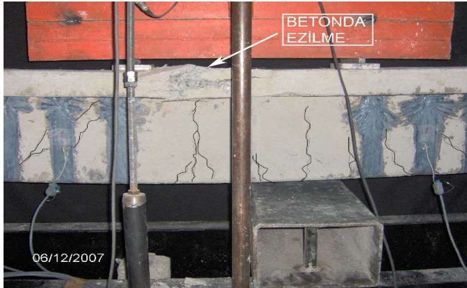
Resim 4.10. Tabla betonunda ezilme, Deney elemanı 6
