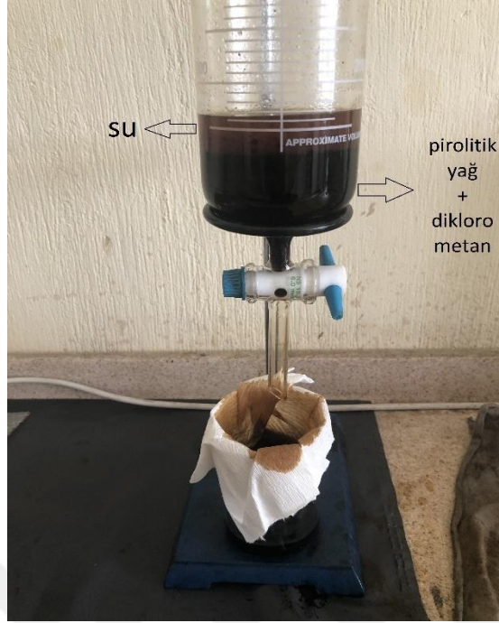
Resim 3.10 Pirolitik yağ ile suyun ayırıştırma işlemi.
