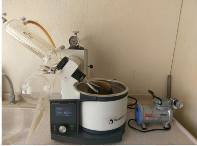
Resim 3.12 Diklorometanın ayrıştırma işlemi.
