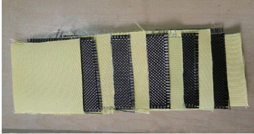
Şekil 3.5 Karışık tabakalı hibrit kompozit dizilimi(Uzay ve ark., 2017)
