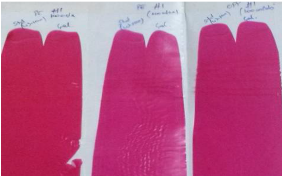
Şekil 4.7 Poliamid reçine esaslı mürekkepte Deneysel ve UK 100 reçinenin karşılaştırılması.
