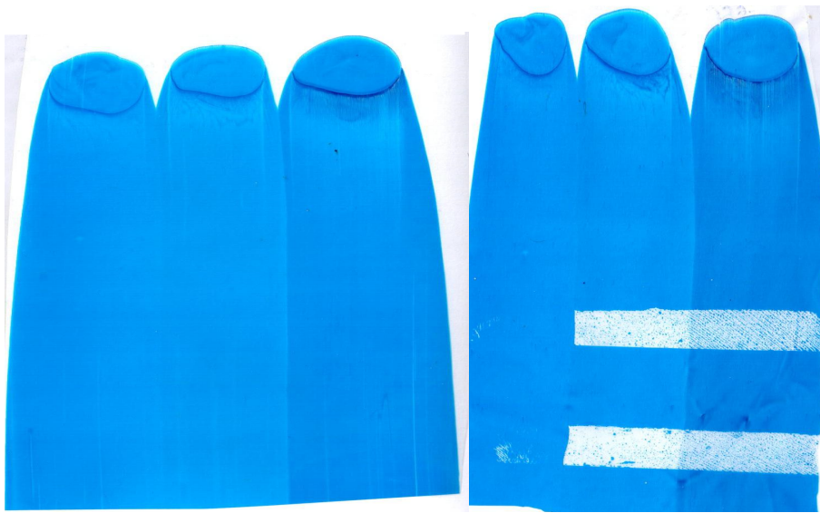
Şekil 4.9 Poli amid esaslı mürekkepte Laropal A81, Deneysel ve UK 100 reçinenin bant testinde karşılaştırılması.
