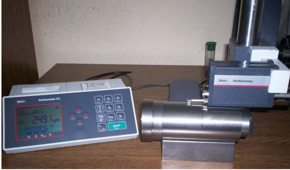
Resim 3.6 Mahr yüzey pürüzlülüğü ölçme cihazı.
