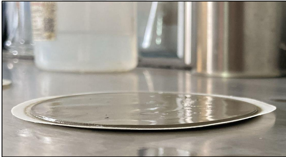
Şekil 5.5. API sıvı kaybı deneyi sonrası filtre kâğıdı üzerindeki çamur keki
