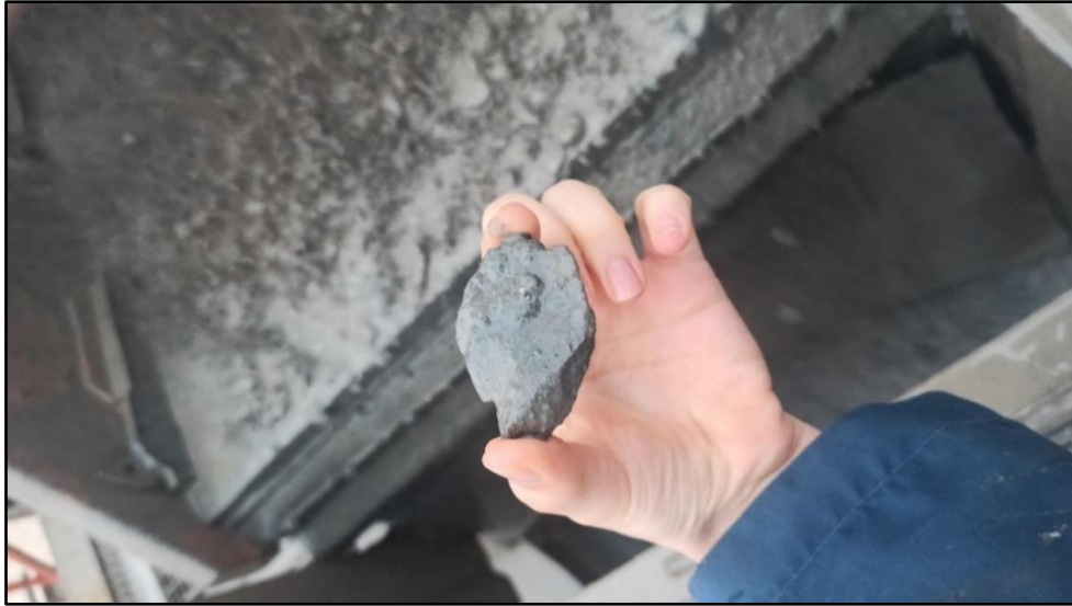
Şekil 6.8. B-1 kuyusuna ait çamur değişikliği sonrası manevra esnasında yıkılan şeyl parçalarının Tez Yazarı Ayşe Orhan tarafından elek başında gösterilmesi
