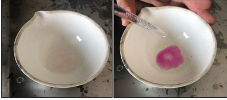
Şekil 5.10. Filtratın fenolftelyn ile renk değişimi
