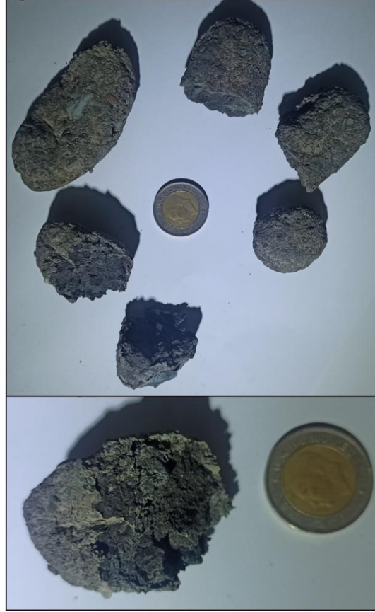
Şekil 6.7. Bu tezde çalışılan B-1 kuyusuna ait polimer (Pac LV ve XCD) etkinliği ile topaklaşan formasyon kesitleri
