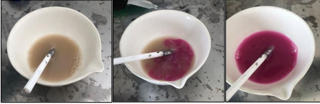
Şekil 5.9. Çamurun fenolftelyn ile renk değişimi
