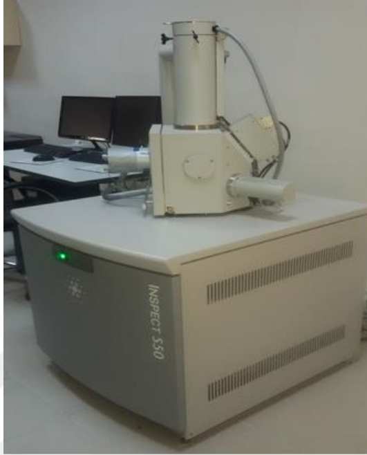
Şekil 3.9. FEI fabrikasına ait SEM cihazının fotoğrafı
