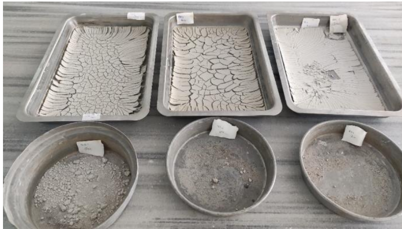
Şekil 4.28. Yıkamalı elek analizi sonrası kurutulmuş No.200 altı ve üstü zemin numuneleri
