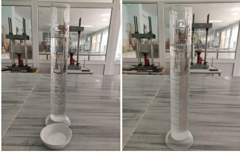
Şekil 4.32. Damıtık su ile dağıtıcı madde karışımının hazırlanması
