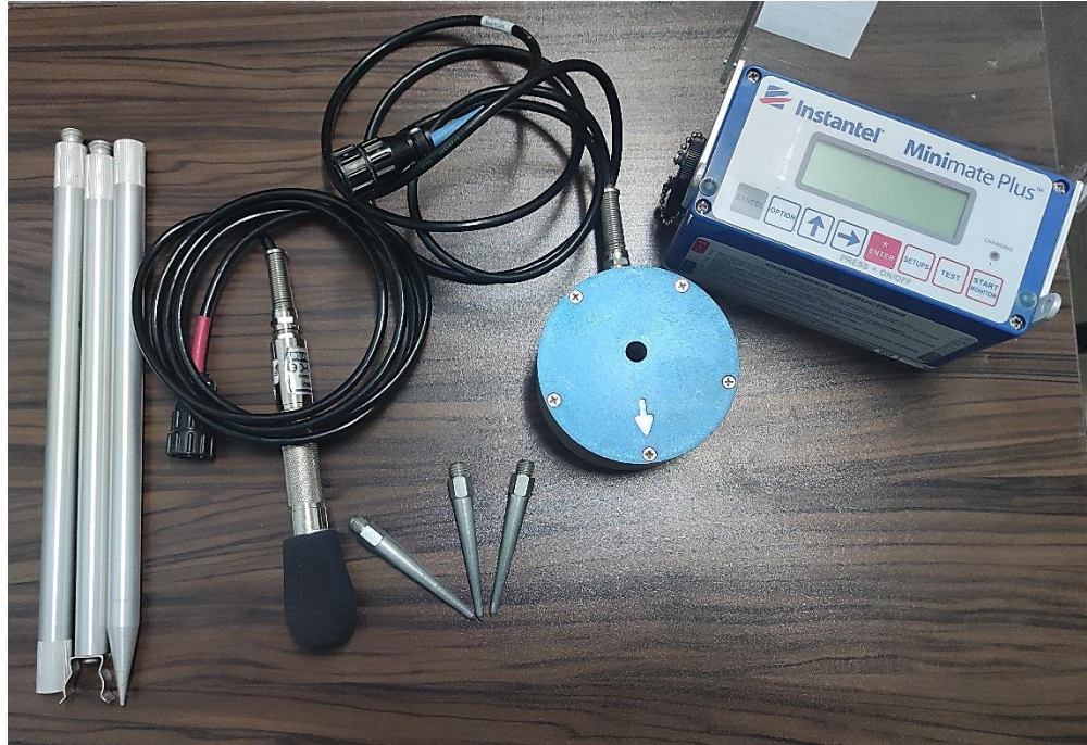
Şekil 4.16. Instantel Minimate Plus titreşim kayıt cihazı ve ekipmanları
