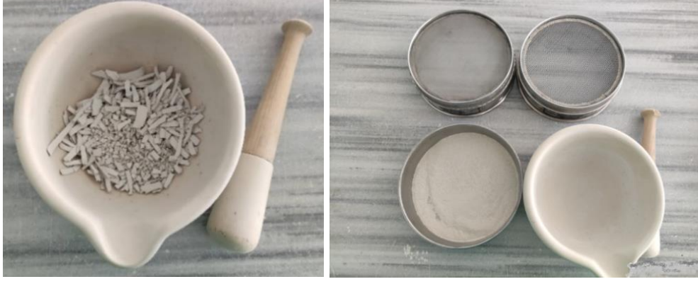
Şekil 4.31. No.200 altı zemin numunesinin öğütülüp hidrometre deneyine hazırlanması
