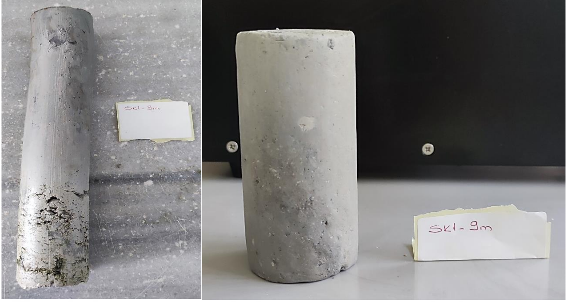
Şekil 5.39. SK1-9 m rezonant kolon deney numunesi
