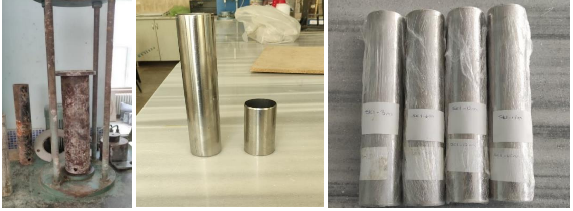
Şekil 4.39. Shelby tüplerinde örselenmemiş zemin numunesi alınması
