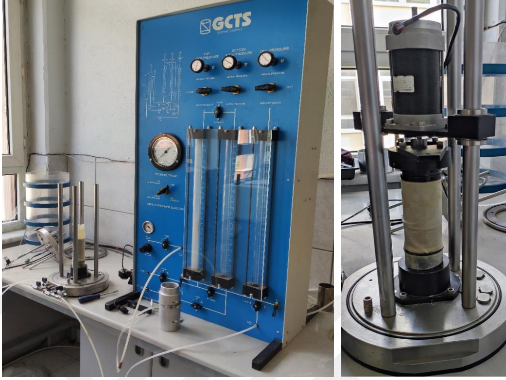
Şekil 2.24. Rezonant kolon deney seti ve zemin numunesinin üstüne yerleştirilen elektromanyetik uyarıcı
