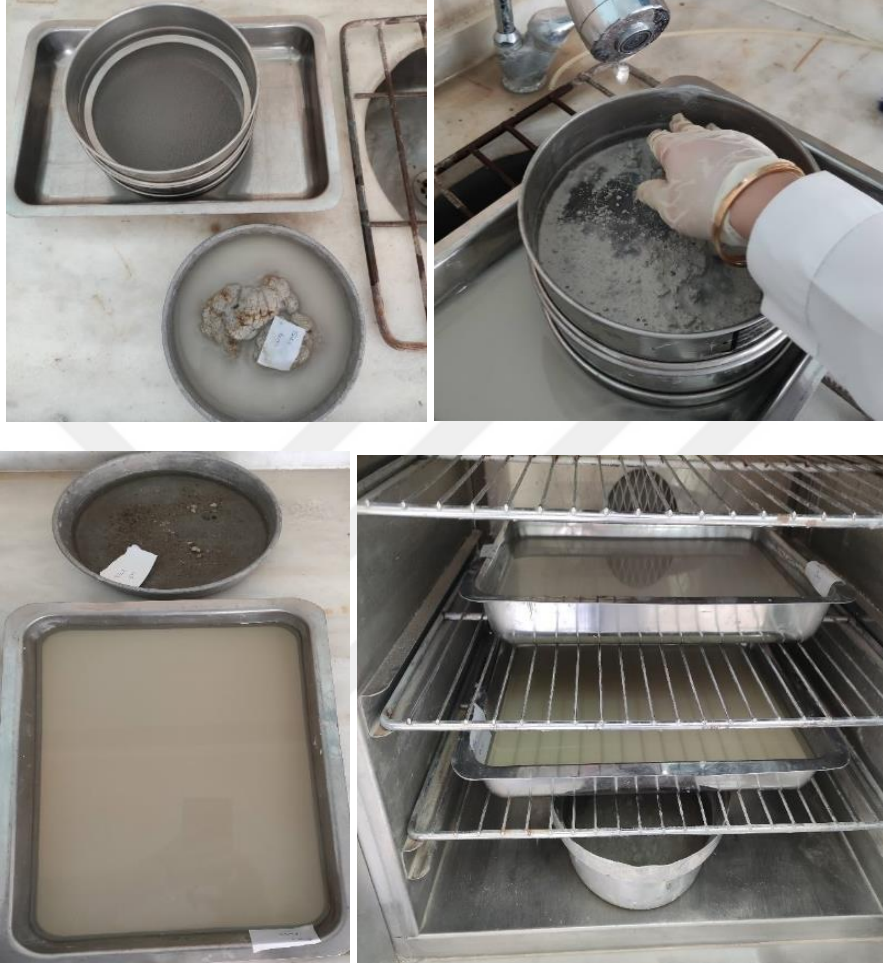
Şekil 4.27. Yıkamalı elek analizi ile ince ve iri daneli zeminin ayrıştırılması ve etüvde kurutulması
