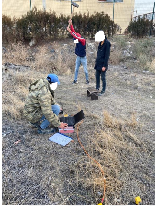
Şekil 4.11. FMC fabrika sahasında yapılan MASW deneyinde balyoz ile uyarımın gerçekleştirilmesi
