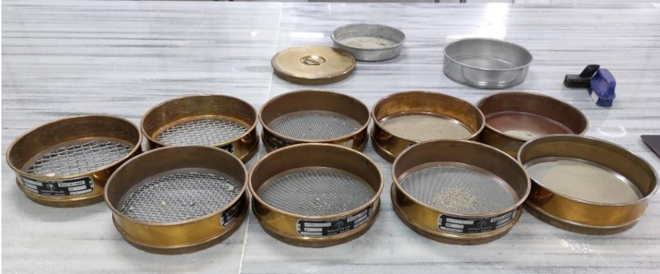
Şekil 4.30. Elek analizi sonrası eleklerde kalan zemin daneleri
