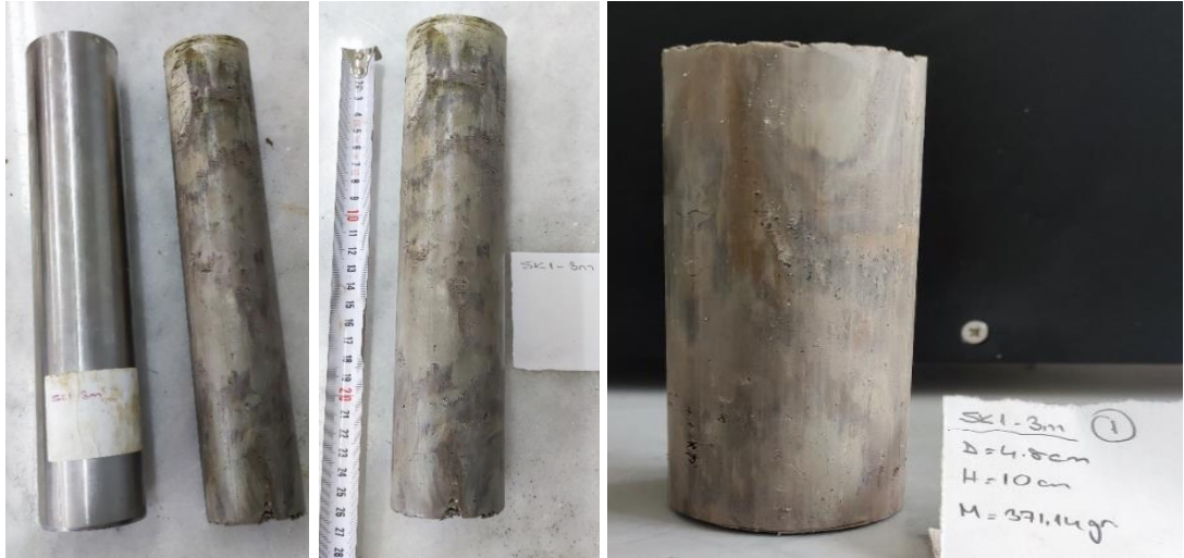
Şekil 4.40. Rezonant kolon deney numunelerinin hazırlanma aşamaları
