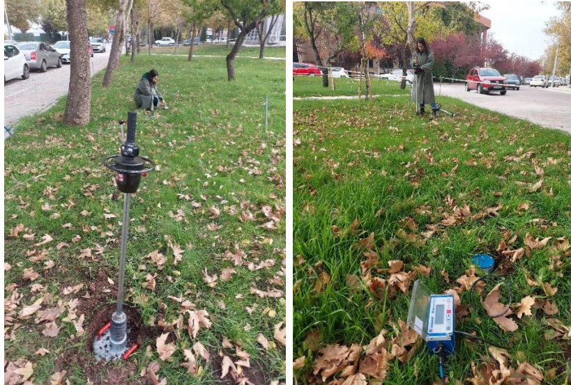
Şekil 4.24. a) KOS Atıksu Arıtma Tesisi sahasında ve b) Selçuk Üniversitesi Kan Merkezi binası bölgesinde yapılan dinamik plaka yükleme deneyi ile dinamik etkinin oluşturulması ve Instantel Minimate Plus cihazları ile ölçümlerin alınması
