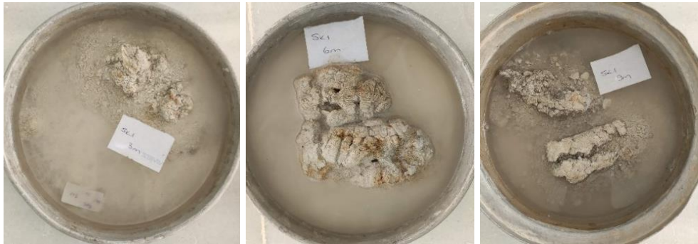
Şekil 4.26. Yıkamalı elek analizi için ıslatılmış zemin numuneleri
