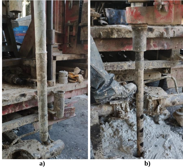
Şekil 4.5. a) SPT numune alıcısının sondaj kuyusuna indirilmesi ve b) Tij üzerinde 45 cm mesafenin işaretlenmesi
