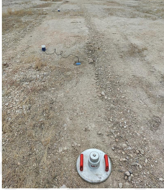
Şekil 4.17. Etki noktası ve jeofonların konumu
