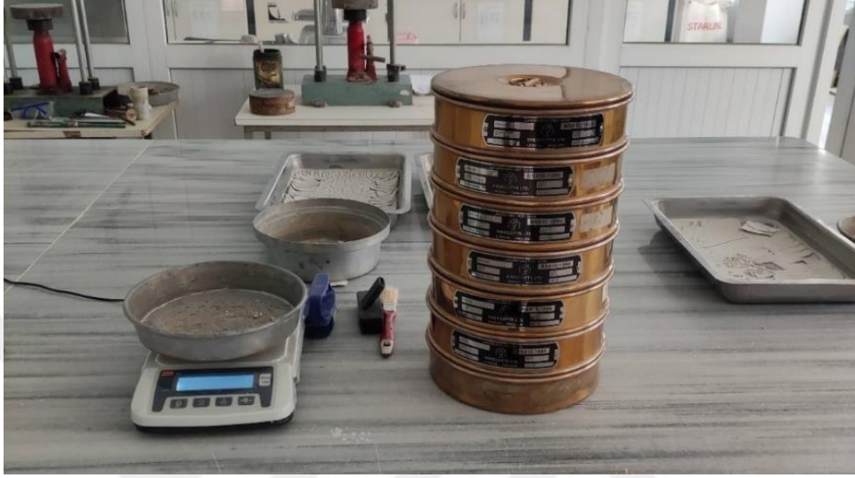
Şekil 4.29. Elek analizi deney ekipmanları
