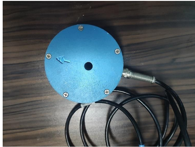
Şekil 4.18. Titreşim kayıtlarını algılayan jeofon
