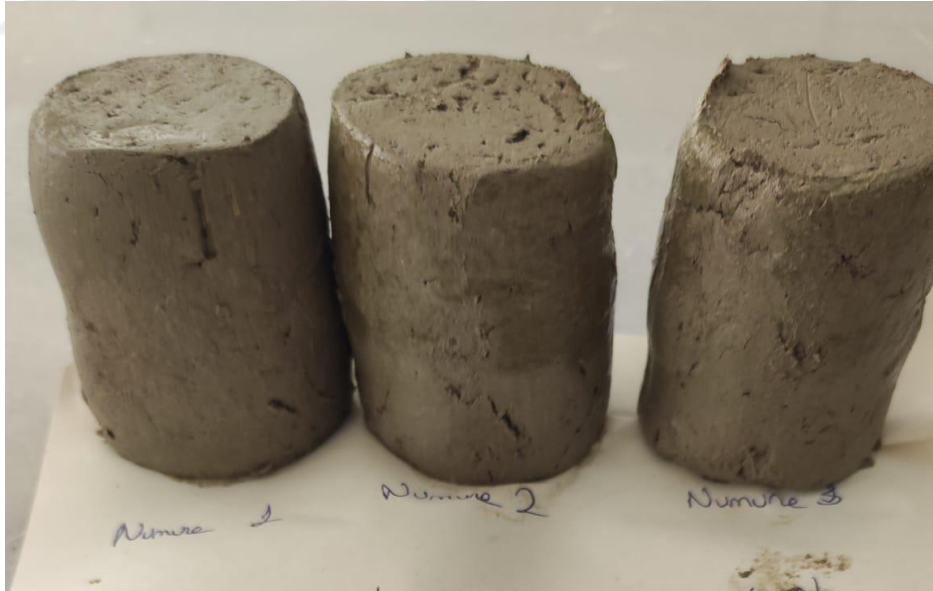
Şekil EK 2.9. Serbest basınç deneyi sonunda numuneler (50 kPa'da konsolide edilmiş )
