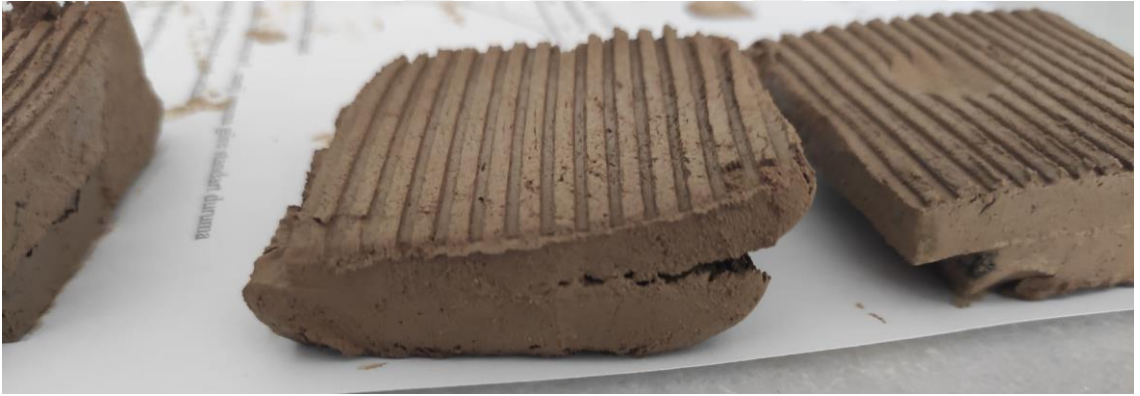
Şekil EK 3.6. Kesme kutusu deney sonunda numuneler (Düşük plastisiteli kil )
