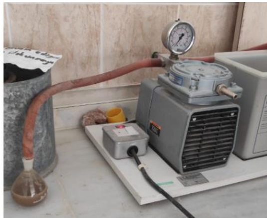
Şekil 4.8 Piknometre deneyi vakumlama işlemi
