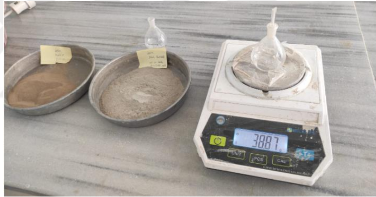
Şekil 4.7. Piknometre deneyi kabın darasının ölçümü işlemi (M1)
