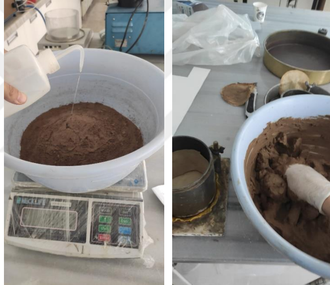
Şekil 4.11. Kil numunenin likit kıvamda hazırlanması
