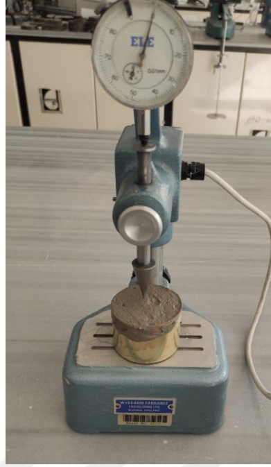
Şekil 4.10. Düşen koni deneyi ile likit limitin belirlenmesi
