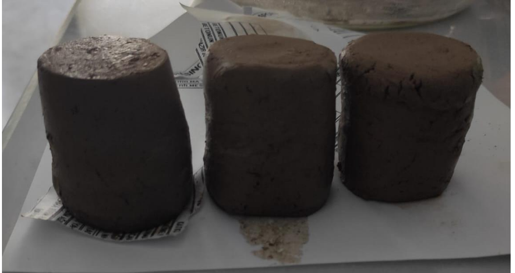
Şekil EK 1.5 Serbest basınç deneyi sonunda numuneler (25 kPa'da konsolide edilmiş )
