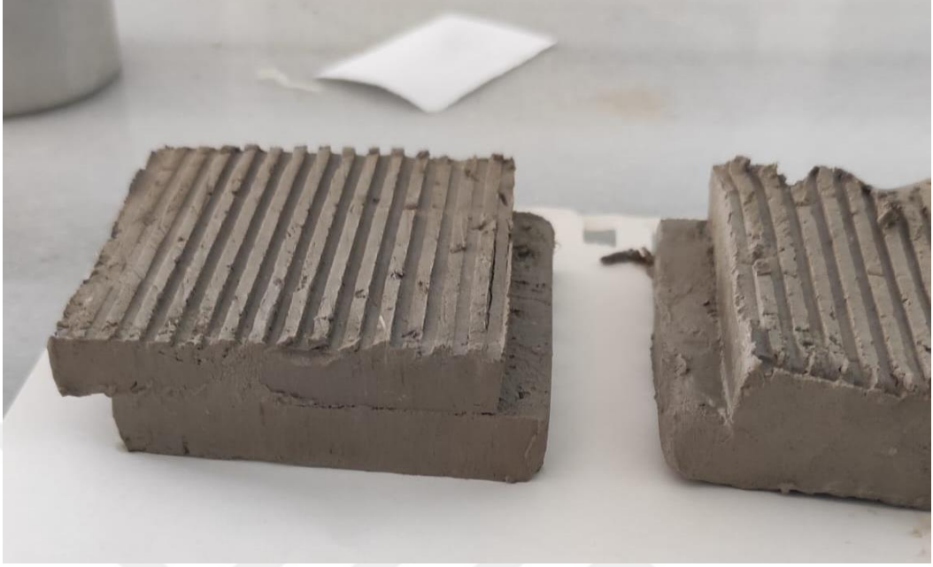
Şekil EK 4.7. Kesme kutusu deneyi sonunda numuneler (Yüksek plastisiteli kil )
