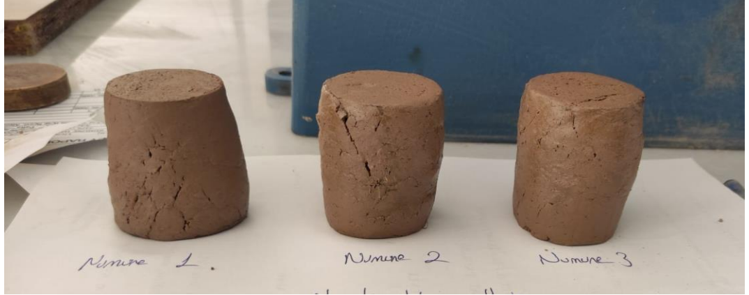
Şekil EK 1.9. Serbest basınç deneyi sonunda numuneler (50 kPa'da konsolide edilmiş )
