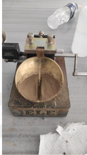
Şekil 4.9. Casagrande aletiyle likit limitin belirlenmesi
