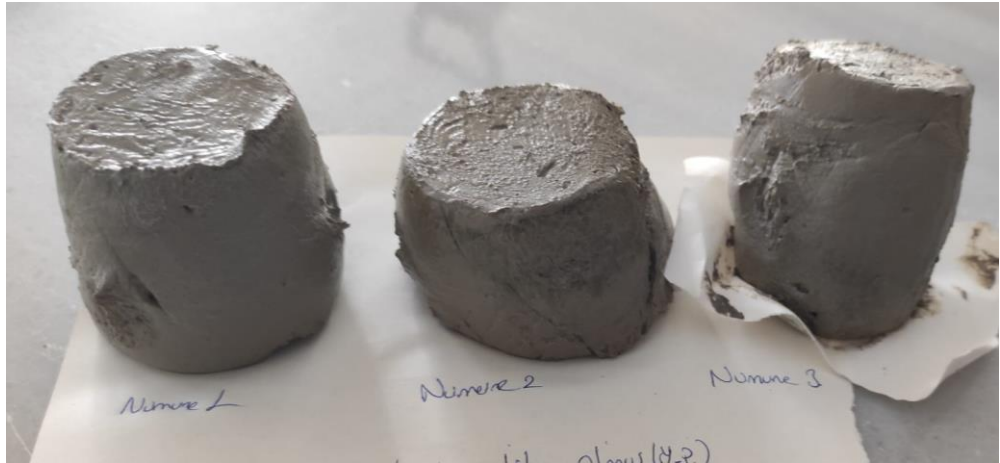
Şekil EK 2.5. Serbest basınç deneyi sonunda numuneler (25 kPa'da konsolide edilmiş )
