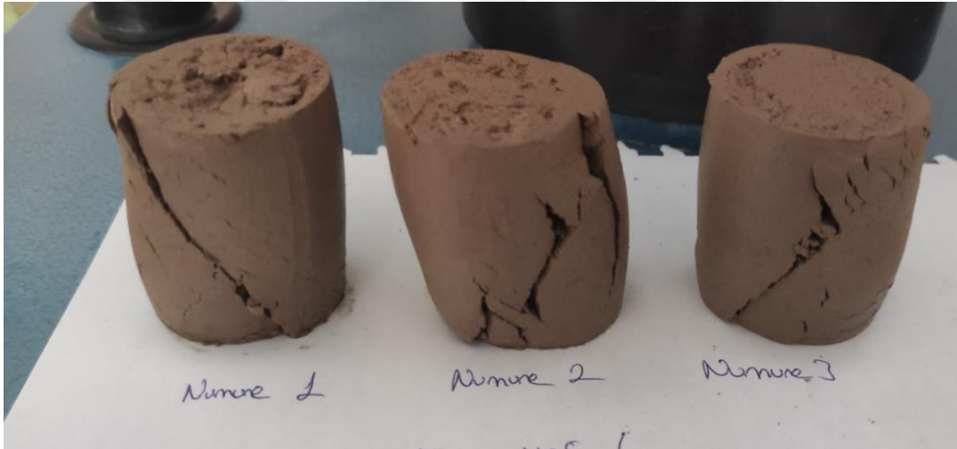
Şekil EK 1.17. Serbest basınç deneyi sonunda numuneler (200 kPa'da konsolide edilmiş )
