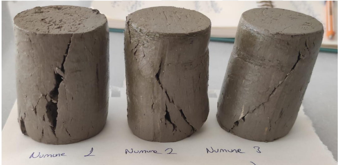
Şekil EK 2.21. Serbest basınç deneyi sonunda numuneler (400 kPa'da konsolide edilmiş )
