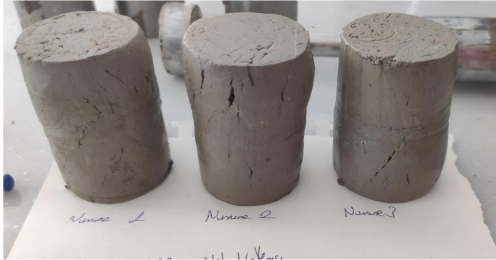
Şekil EK 2.17. Serbest basınç deneyi sonunda numuneler (200 kPa'da konsolide edilmiş )
