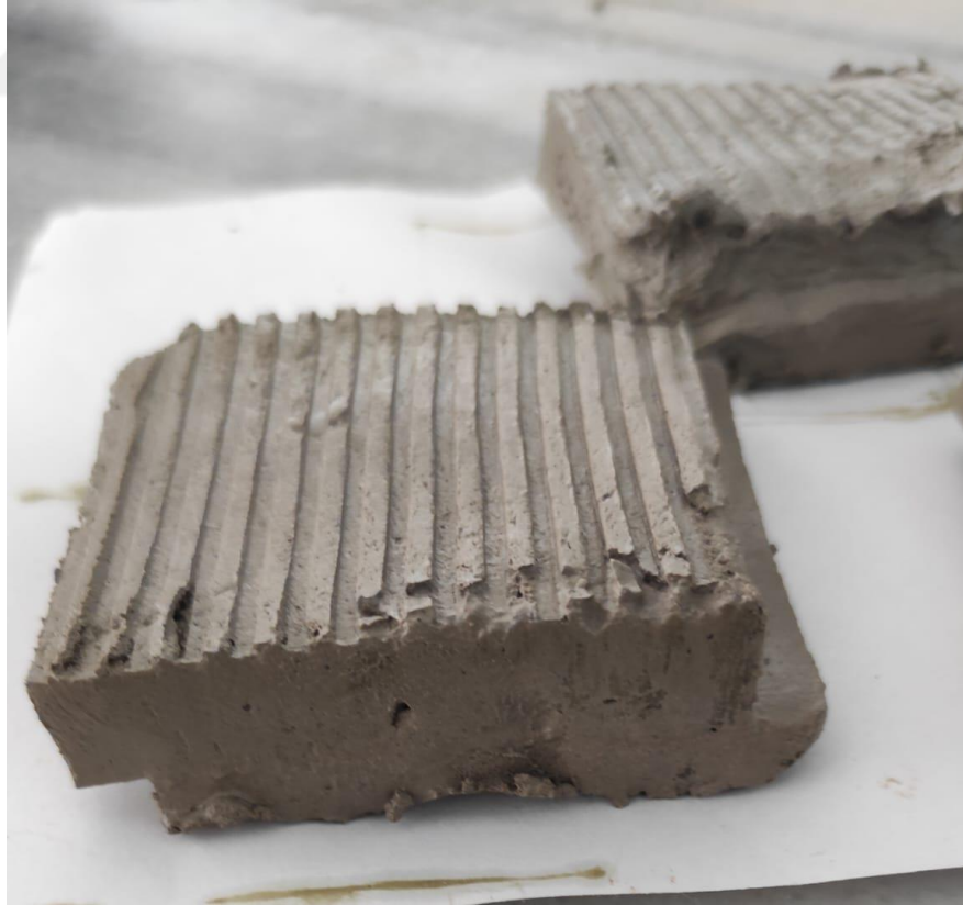
Şekil EK 4.6. Kesme kutusu deneyi sonunda numuneler (Yüksek plastisiteli kil )
