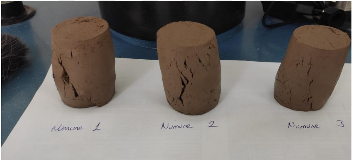
Şekil EK 1.13. Serbest basınç deneyi sonunda numuneler (100 kPa'da konsolide edilmiş )
