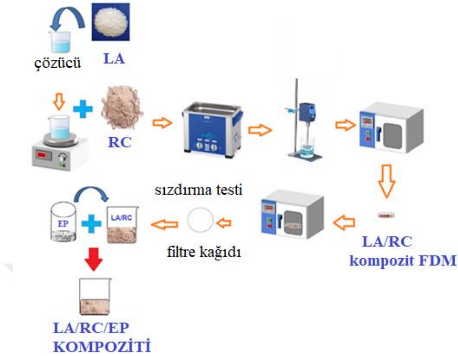
Şekil 3.1. LA/RC kompozit FDM'lerin üretim süreci
