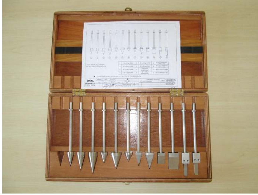
Şekil 3.1 Konik penetrasyon uçların genel görünümü (kutu içeriği ile birlikte yerleşim düzeni)
