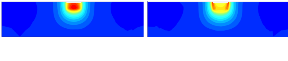
c) Yayılı yüklü kazıklı modelde temelde oluşan deplasmanlar (plan ve kesit görünüşü)
