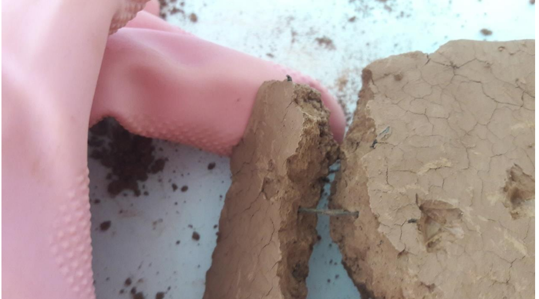
Şekil 5.7: Lastik parçacığı ile kil numunenin birbirine tutunma görüntüsü
