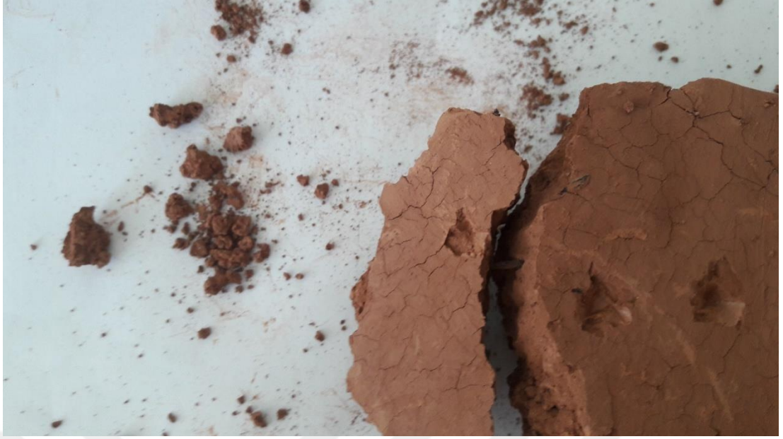
Şekil 5.8: Lastik parçacığı ile birbirine tutunmuş diğer kil numune görüntüsü
