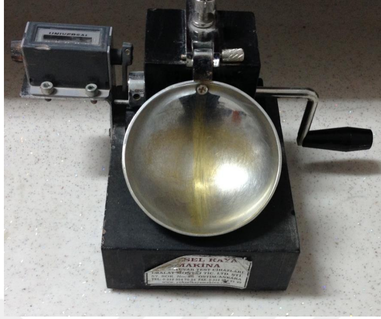
Şekil 3.6: Likit limit deney aleti (Casagrande aleti).
