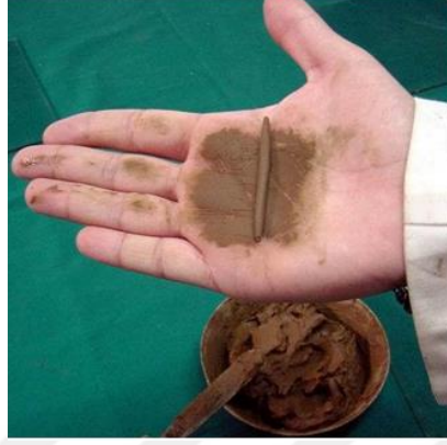
Şekil 3.10: PL için kil numunenin şerit haline getirilmesi
