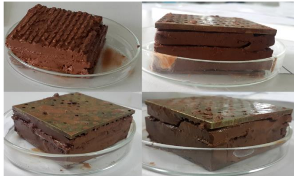
Şekil 3.15: Kesme kutusu deney numuneleri
