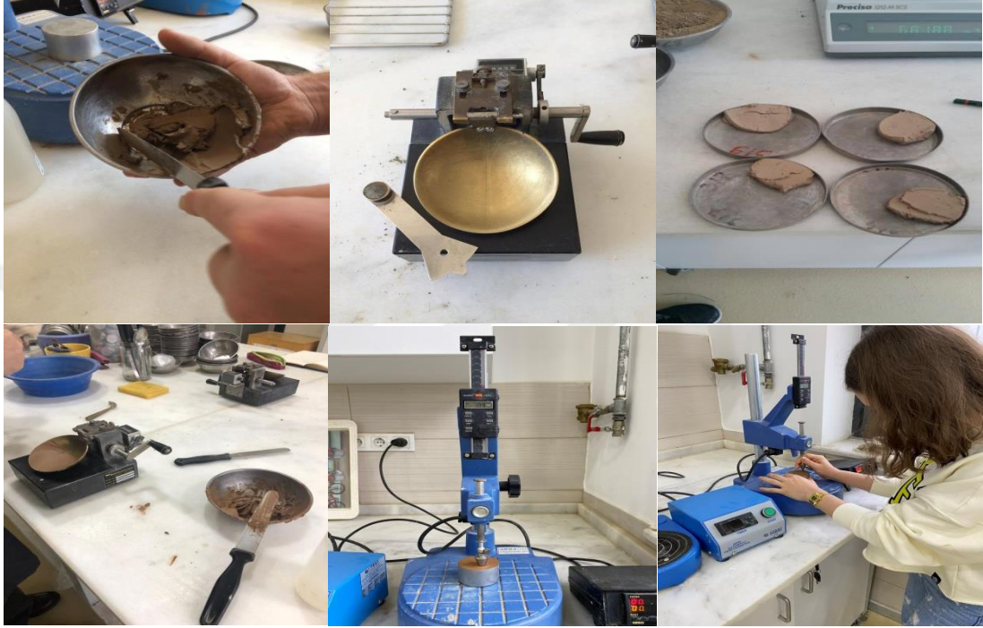
Şekil 4.4. Casagrande ve Konik Penetrometre deneyi yapılışı.
