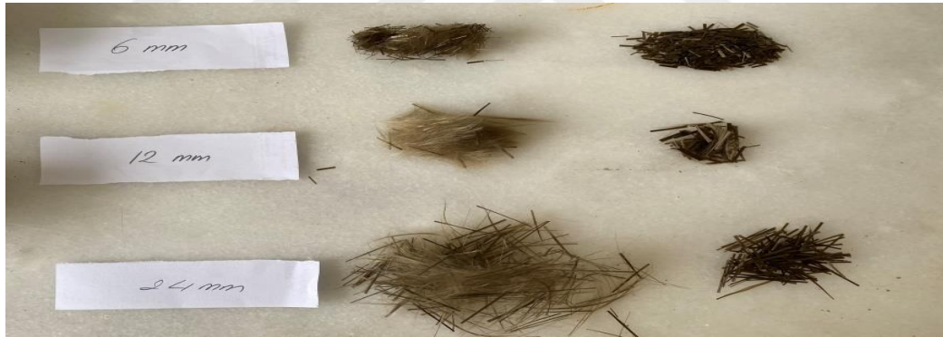
Şekil 4.9. Farklı uzunluktaki bazalt fiberlerin basınçlı hava ile ayrıştırılmış ve orijinal halleri.
