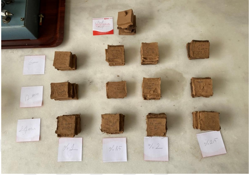
Şekil 4.13. Kesme kutusu deneyi sonrası bütün zemin örnekleri.
