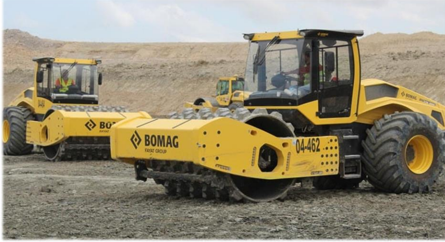
Şekil 2.4: Yüzey kompaksiyon yönteminden keçi ayaklı silindir ( www.sanalşantiye.com )
