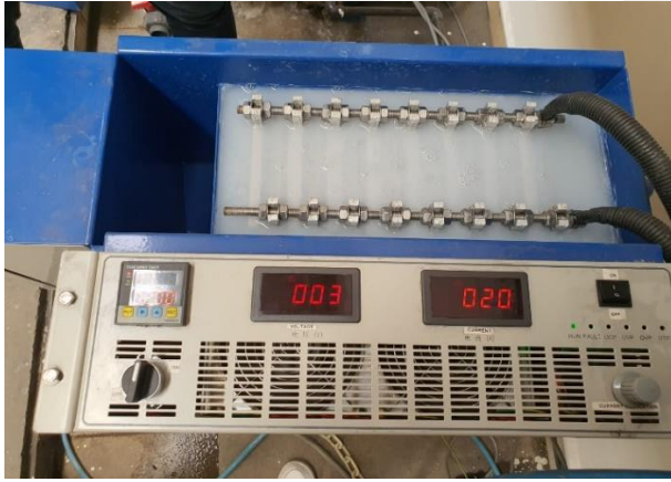
Şekil 4.3. RO konsantre akımının EC reaktörü ile arıtımı
