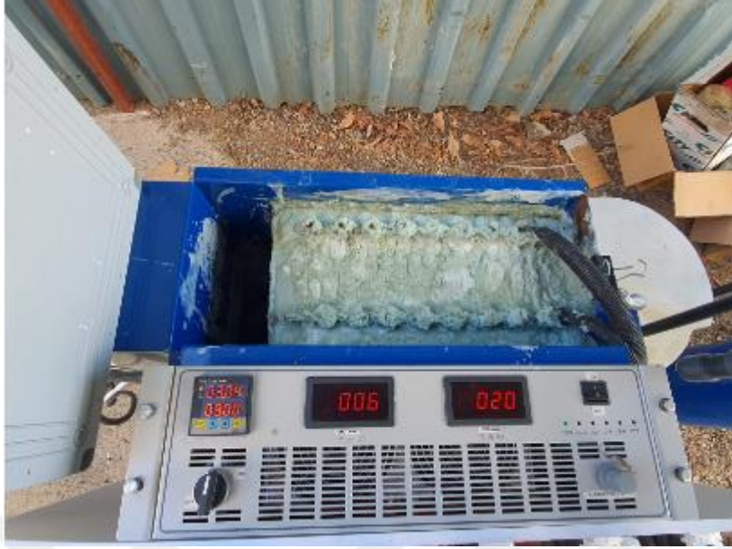
Şekil 3.11. EC reaktörü ile gübre ve zirai ilaç endüstrisi atıksuyu arıtım çalışmaları
