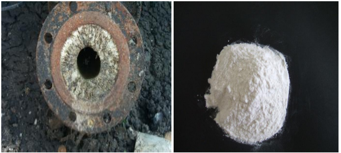
Şekil 2.1. Struvit oluşumu ile kesit daralması(Atalay, 2006) ve struvitin toz hali
