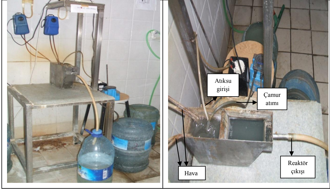
Şekil 3.1. Biyokatalitik kalsifikasyon reaktörü (BCR)
