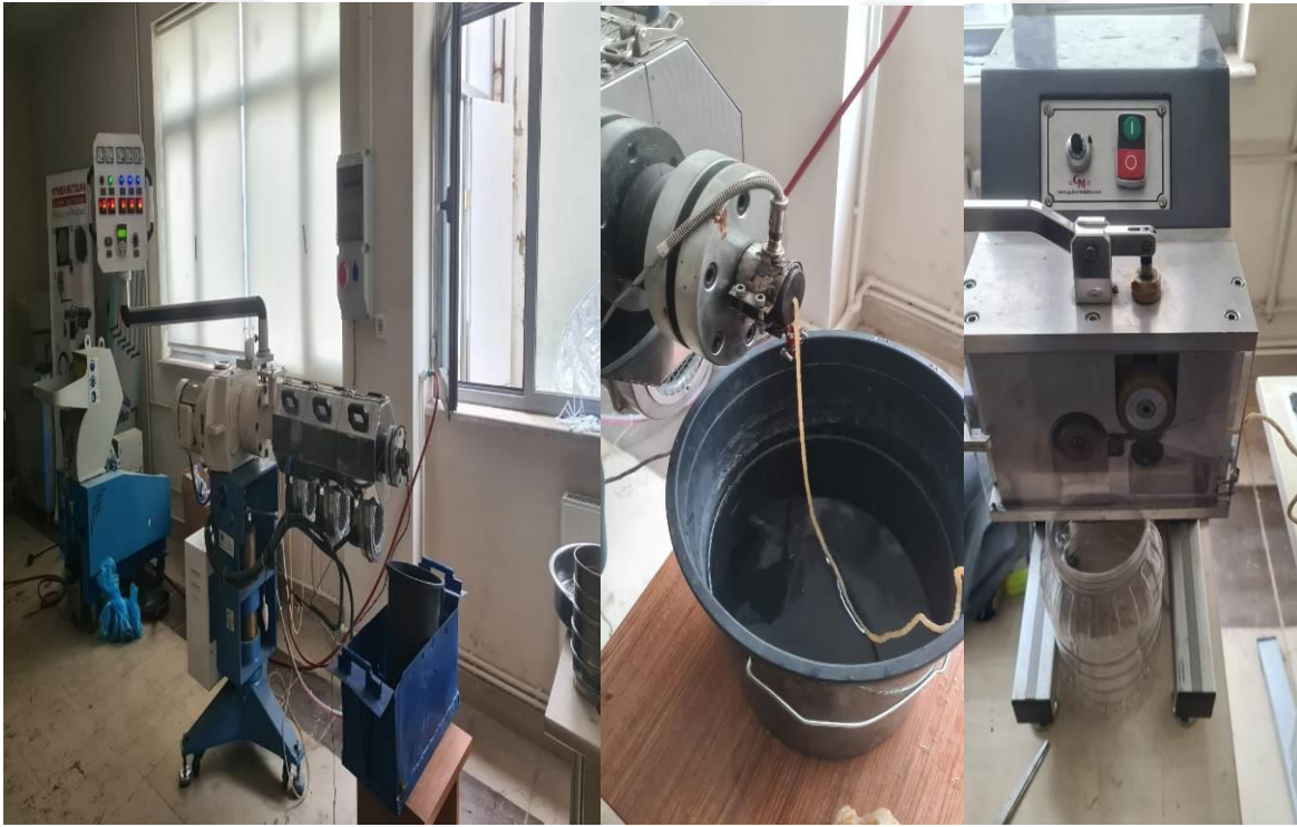
Resim 5.4. Ekstrüzyon yöntemi ile homojen karışım üretimi
