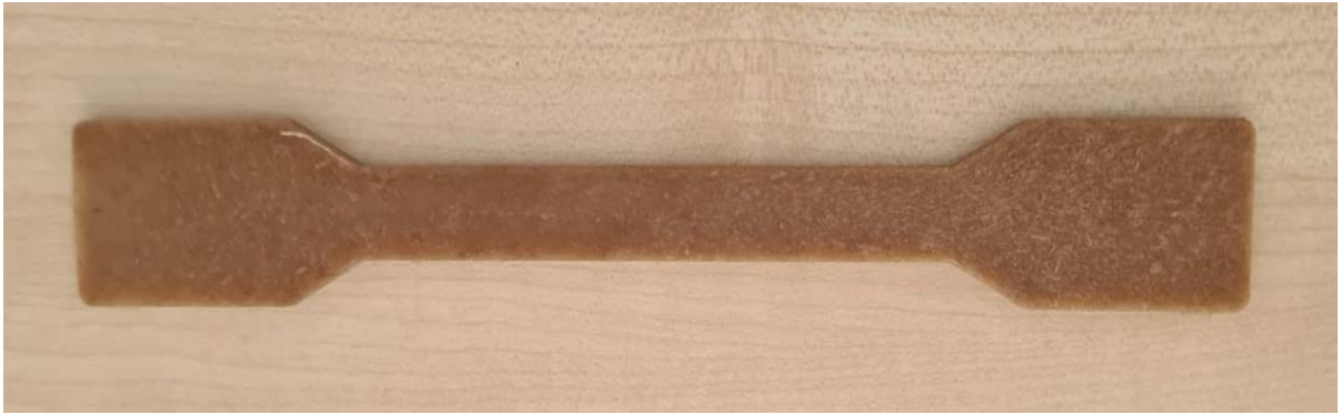
Resim 5.6. Enjeksiyon kalıplama ile üretilen standart çekme test numunesi
