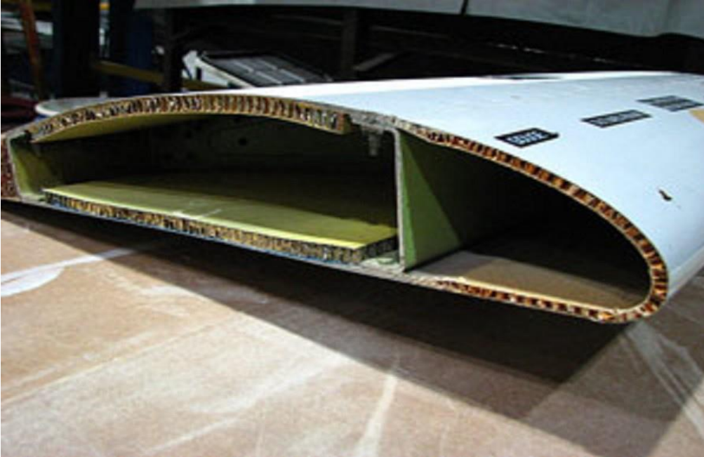
Resim 3.1. Kompozit malzemelerden üretilen uçak kanadı (URL-5, 2022)
