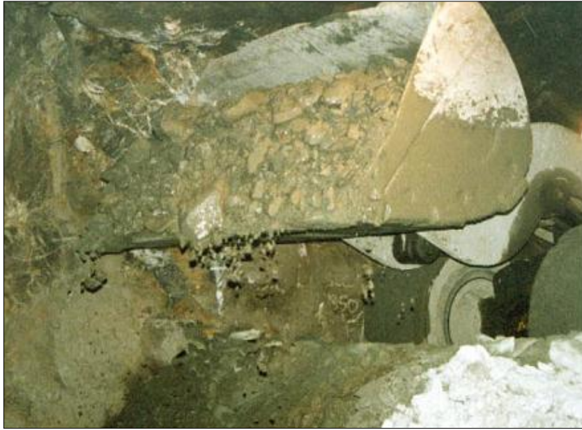
Şekil 1.1. Çimentolu kaya dolgusu boşluklara yerleştirilirken (Dorricott ve Grice, 2002).
