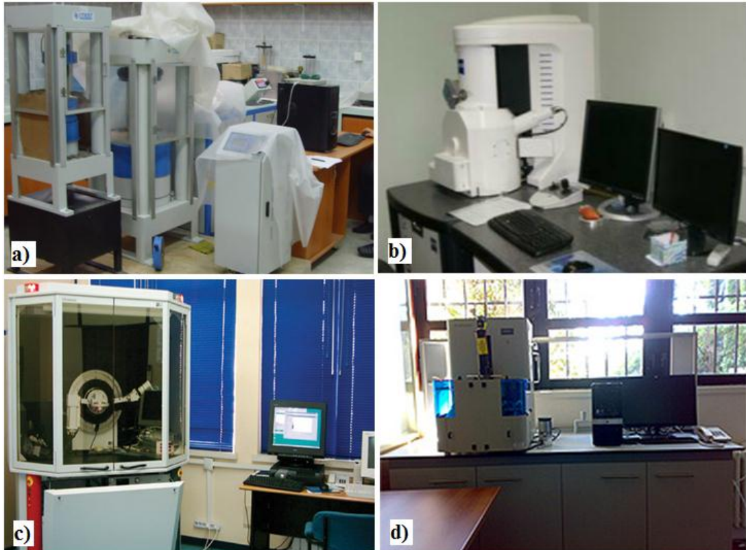
Şekil 2.12. Sertleşmiş numunelere yapılan deneysel çalışmalarda kullanılan cihazlar; tek eksenli basma dayanım aleti (a), SEM analizi deney aleti (b), XRD analizi deney aleti (c) ve civa porozimetresi deney aleti (d)
