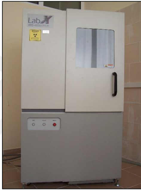
Resim 3.16 Döğer tüfünün mineral bileşiminin belirlenmesinde kullanılan XRD cihazının görünümü.
