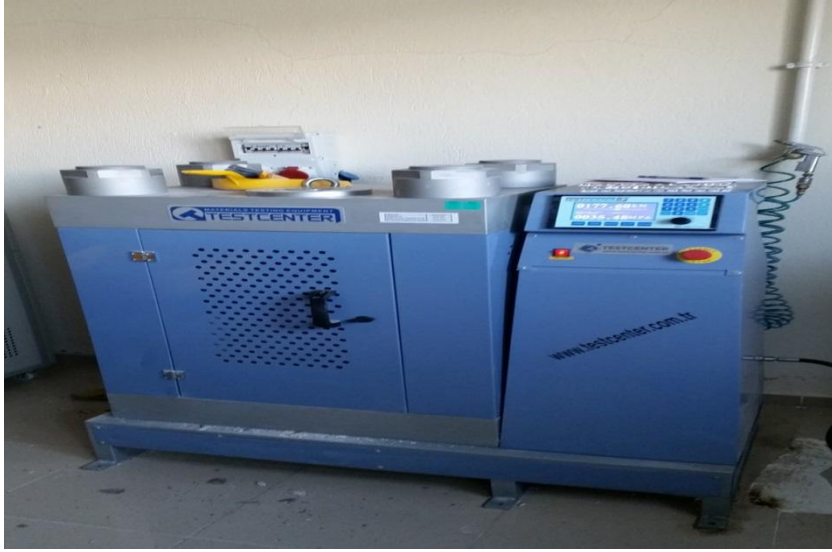
Resim 3.20 Tek eksenli basınç dayanımı cihazı.
