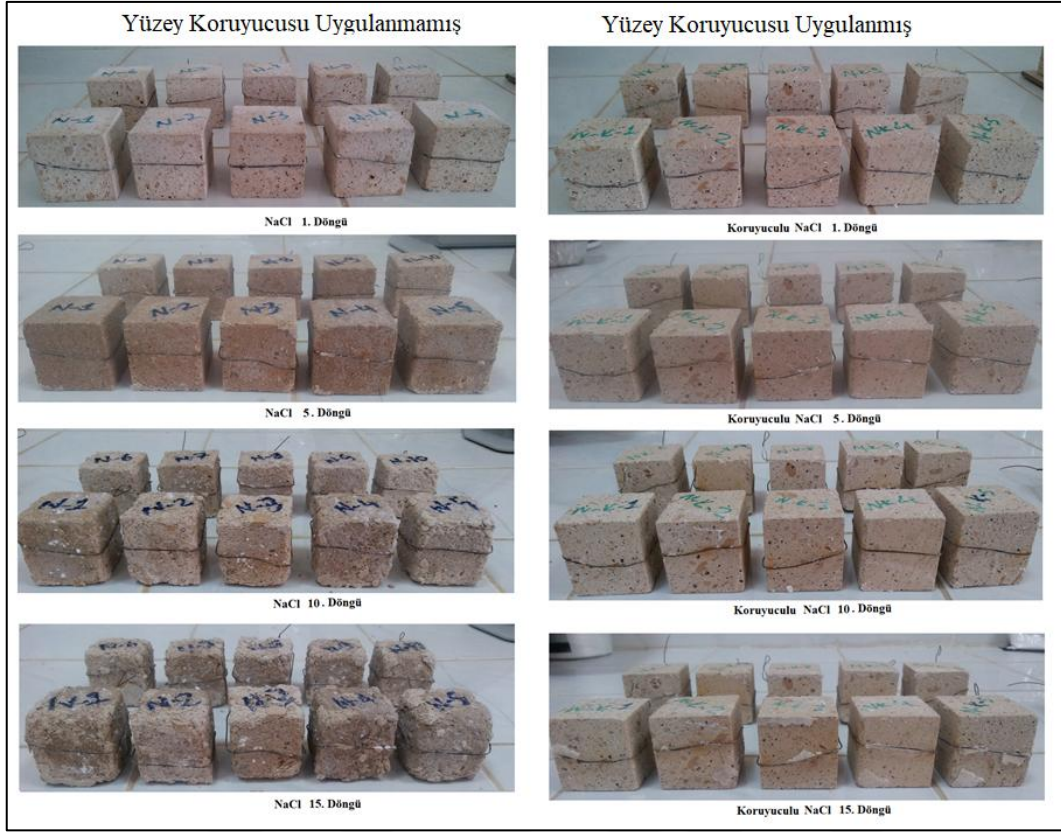
Resim 4.3 Yüzey koruyucusu uygulanmamış ve uygulanmış Döğ tufünün tuz kristallenmesi (NaCl) deneyinde 1-5-10-15. döngülerin görünümleri.
