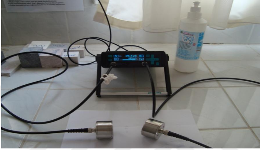
Resim 3.19 Proceq Pundit Lab ultrasonik test cihazı.
