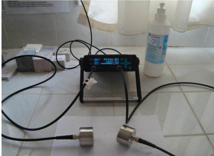
Resim 3.10 Proceq Pundit Lab ultrasonik test cihazı.
