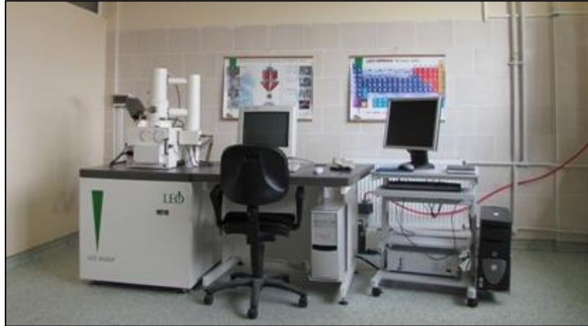
Resim 3.15 Döğer tüfünün mikro özelliklerin belirlenmesinde kullanılan SEM cihazının görünümü.
