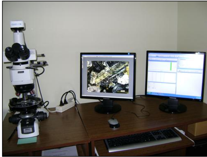
Resim 3.14 Döğer tufünün mineralojik ve petrografik özelliklerin belirlenmesinde kullanılan Polarizan mikroskop cihazının görünümü.
