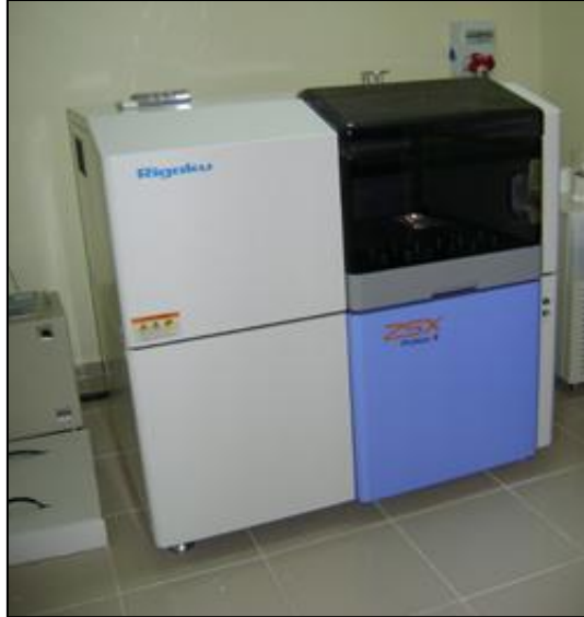
Resim 3.13 Doğer tüfünün kimyasal bileşiminin belirlenmesinde kullanılan XRF cihazının görünümü.
