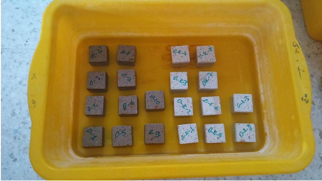
Resim 3.23 Kapiler su emme deneyi.
