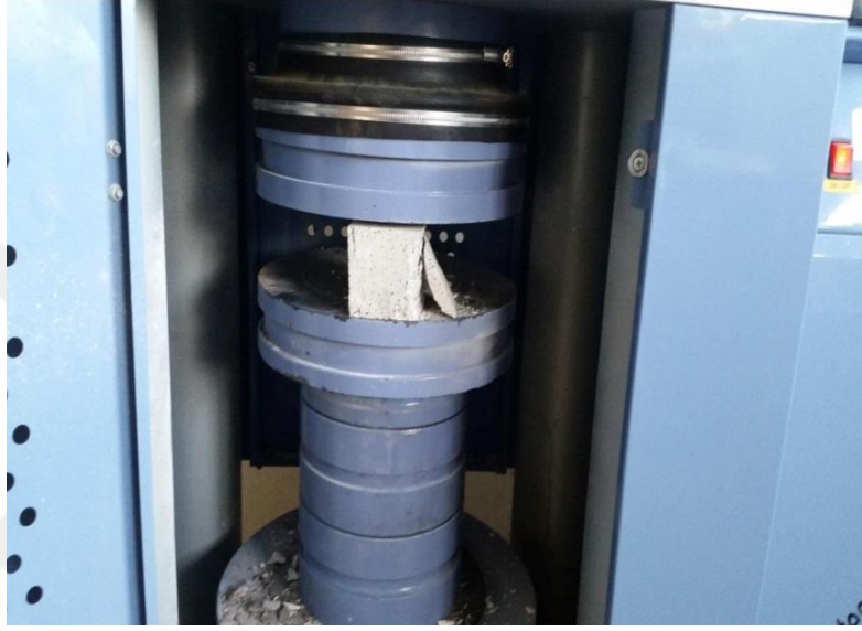
Resim 3.21 Örneğin tek eksenli basınç dayanımı deneyinde kırıldığı andaki görüntüsü.
