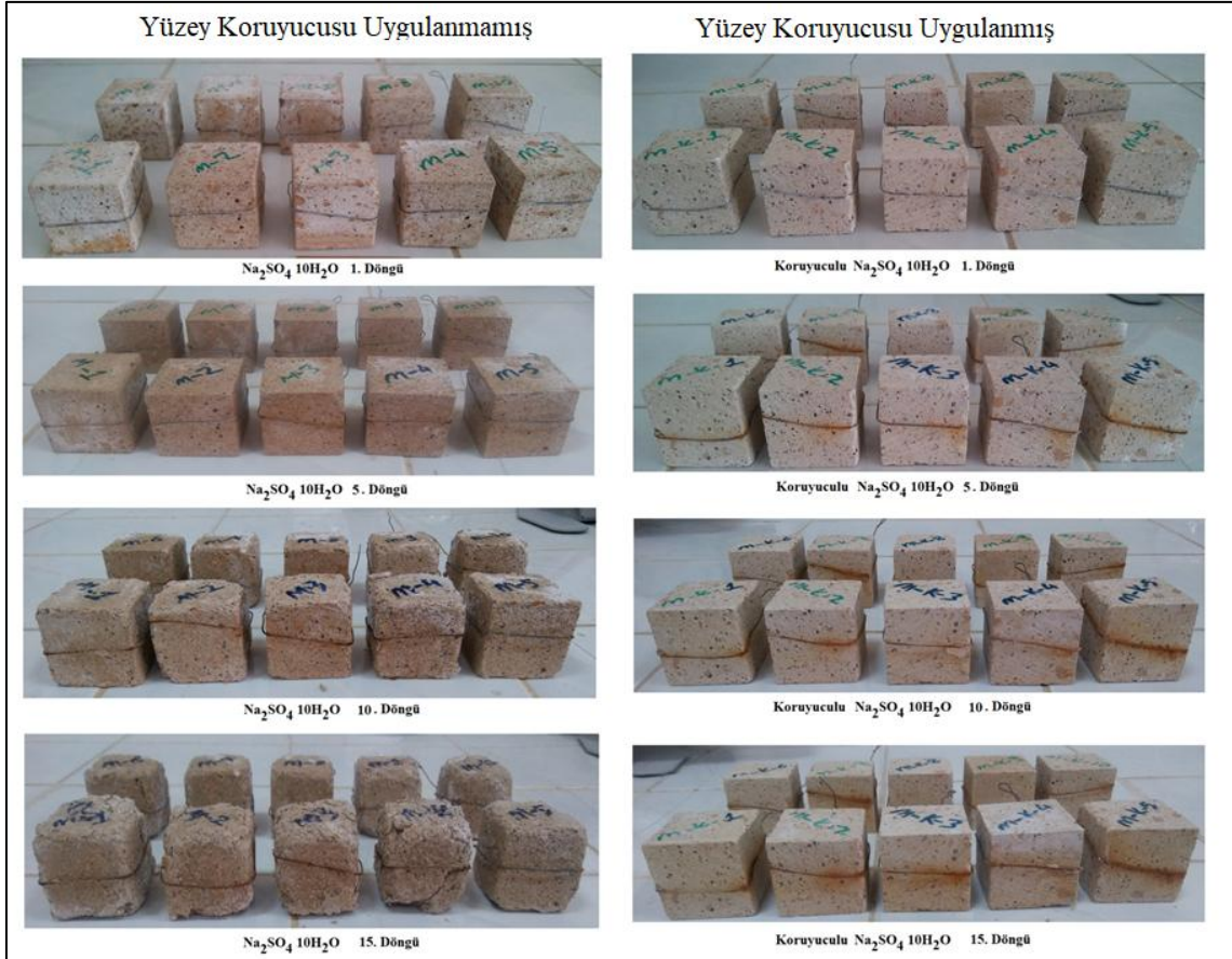
Resim 4.4 Yüzey koruyucusu uygulanmamış ve uygulanmış Döğer tüfünün tuz kristallenmesi ( \text{Na}_2\text{SO}_4 \cdot 10\text{H}_2\text{O} ) deneyinde 1-5-10-15. döngülerin görünümleri.
