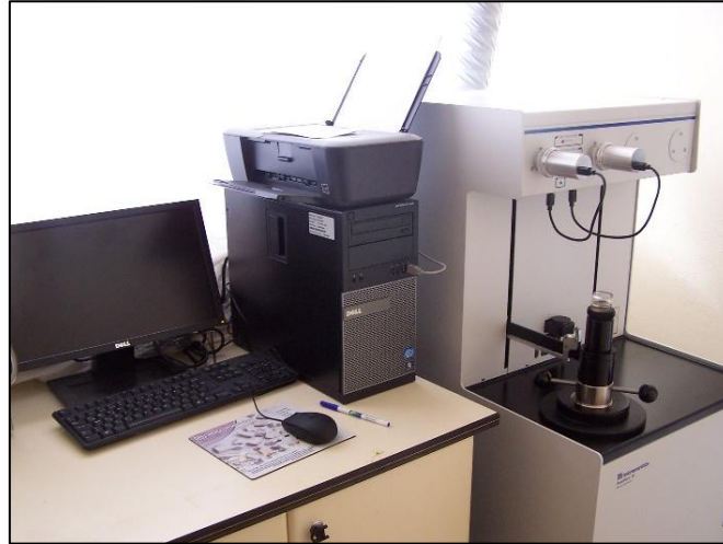
Resim 3.17 Döğer tüfünün gözenek boyut dağılımı özelliklerin belirlenmesinde kullanılan cıvalı porozimetre cihazı.
