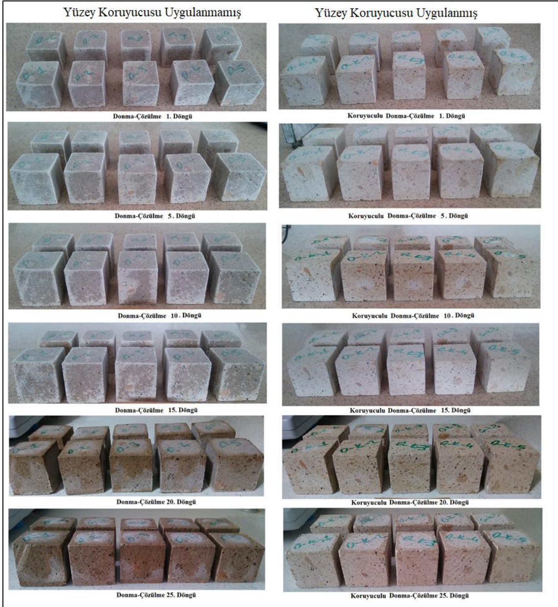
Resim 4.2 Yüzey koruyucusu uygulanmamış ve uygulanmış Döğertufün don tesirlerine dayanıklılık deneyi görünüşleri.
