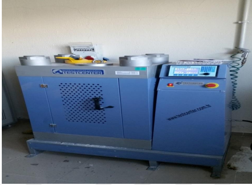
Resim 3.9 Testcenter marka tek eksenli basınç dayanım cihazı.
