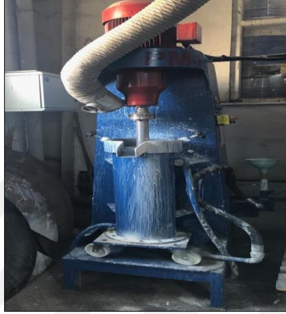
Şekil 3.8: Renk Pastası Hazırlamada Kullanılan Pearl Mill Makinesi
