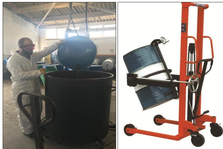
Şekil 3.17: Varilden Hammadde Aktarımında İş Ekipmanı Kullanımı
