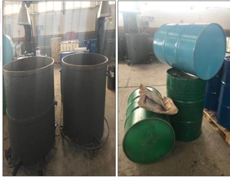
Şekil 3.18: Ağzı Açık Kazanlar ve Güvensiz Duran Variller
