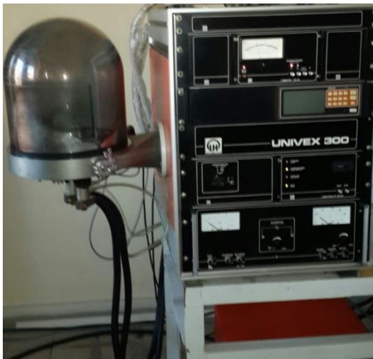
Şekil 3.1. Buharlaştırma işlemi için kullanılan cihaz.
