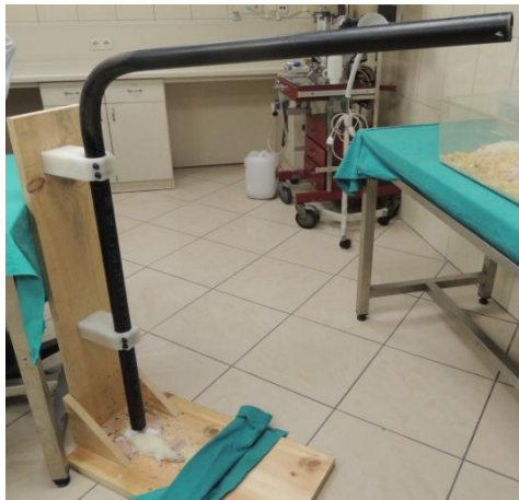
Resim 8a: Top düşürme tekniği düzeneği.
