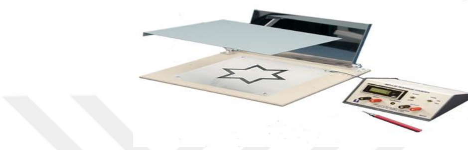
Şekil 3.3. Lafeyette yıldız testi a) çift el-göz koordinasyon test aleti b) uyarıcı sayaç
