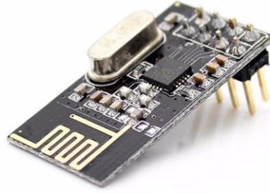
Şekil 3.9 NRF24L01 RF haberleşme kartı.
