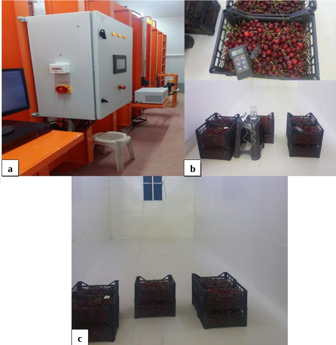
Şekil 3.3. Çalışmada kullanılan vakumla ön soğutma sistemi (a), Vakumla ön soğutma uygulaması (b) ve Vakumla ön soğutma yapılmış kiraz meyvelerinden görünüm (c)
