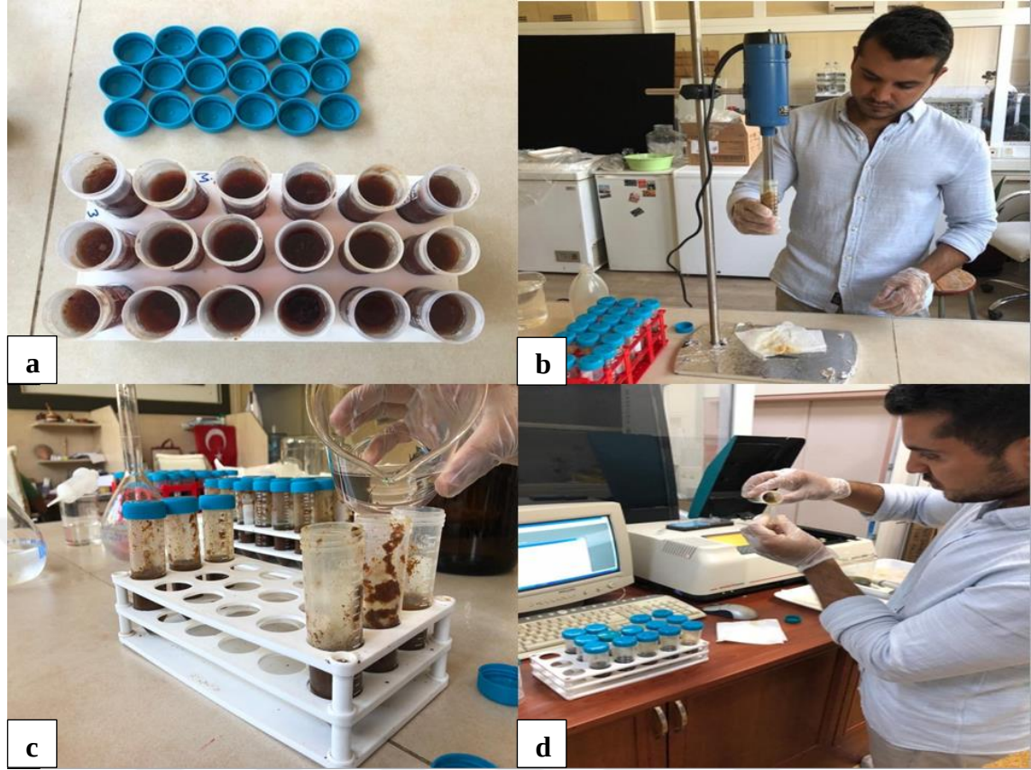
Şekil 3.10. Klorofil analizinden bazı görünüm (a), örneklerin homojenizasyon işlemi (b), örneklerin üzerine aseton eklenmesi (c), spektrofotometrede örneklerin okutulması (d)
