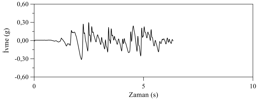
Şekil 8: İmperial Valley Depreminin ELC180 Bileşenine Ait İvme Kaydı
