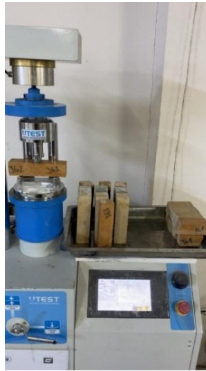
Şekil 3.11. 3 noktalı eğilmede çekme dayanımı deneyi
