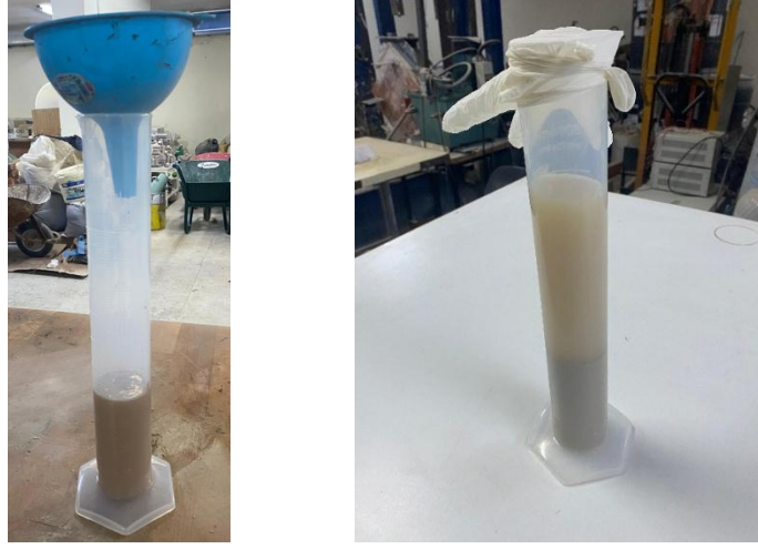
Şekil 3.7. Hava muhtevası tayininde kullanılan mezür düzeneği ve alkol yer değiştirme yöntemi
