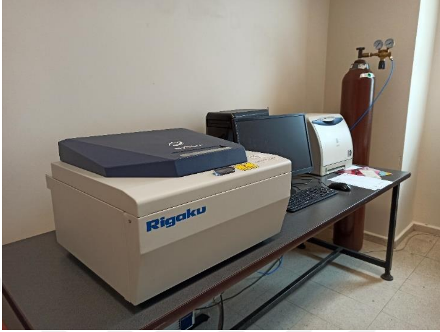
Şekil 3.7. X-Işını floresans spektrometresi (XRF) cihazı
