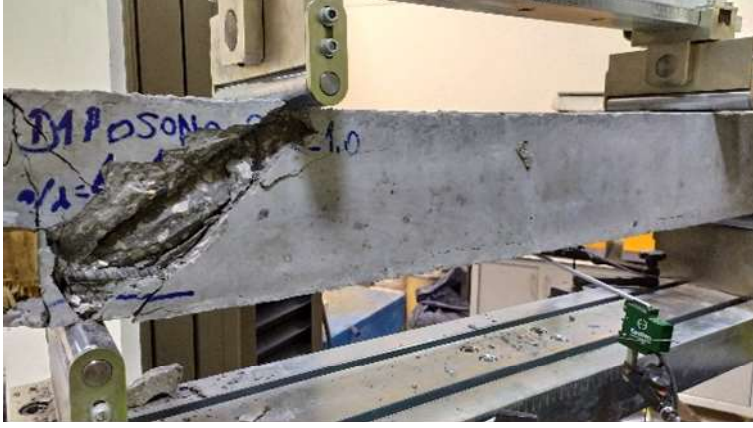
Resim 4.14. D1P0S0N0_0,70_1,0 numunesinin 0,67a/d oranındaki 28 günlük göçme görüntüsü
