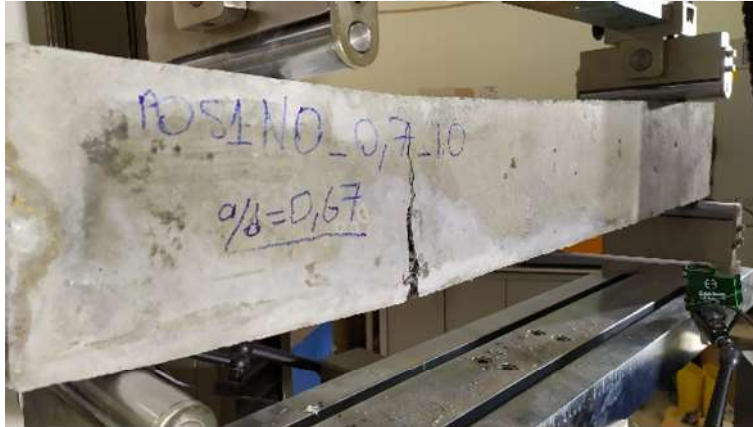
Resim 4.11. P0S1N0_0,70_1,0 numunesinin 0,67a/d oranındaki 28 günlük göçme görüntüsü
