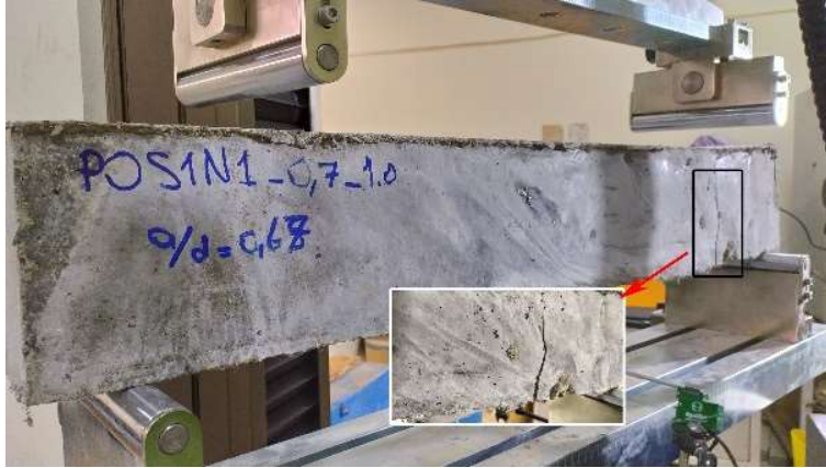
Resim 4.12. P0S1N1_0,70_1,0 numunesinin 0,67a/d oranındaki 28 günlük göçme görüntüsü
