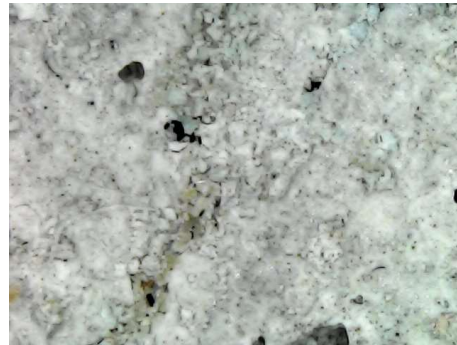
Resim 4.16. (devam) Kiriş numunelerinin çatlak oluşumu ve iyileşme sonrası bazı görüntü örnekleri
