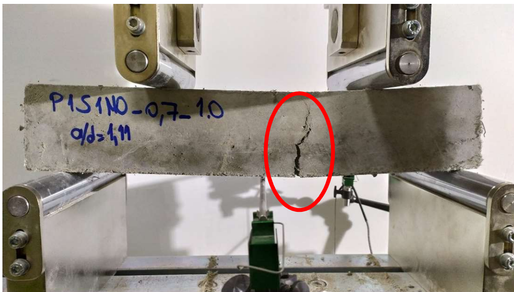
Resim 4.8. P1S1N0_0,70_1,0 kodlu numunenin 1,11 a/d oranındaki kırılma çatlağı görüntüsü
