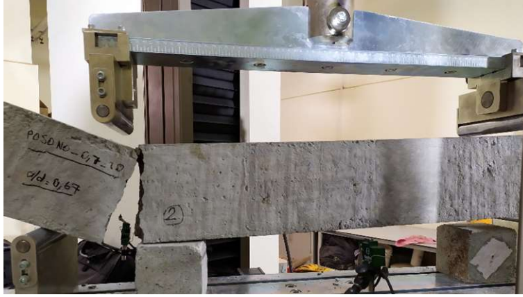
Resim 4.10. P0S0N0_0,70_1,0 numunesinin 0,67a/d oranındaki 28 günlük göçme görüntüsü
