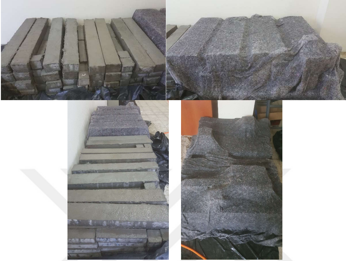
Resim 3.3. Numunelerin kürlenmesi ve nemli bez yardımıyla nem kaybının önlenmesi
