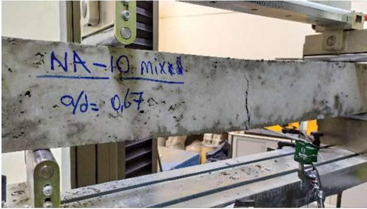
Resim 4.15. NA-P1S1N0_0,70_1,0 numunesinin 0,67a/d oranındaki 28 günlük göçme görüntüsü
