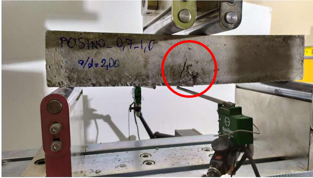
Resim 4.3. POS1N0_0,70_1,0 kodlu numunenin 2,00 a/d oranındaki kırılma çatlakları görüntüsü
