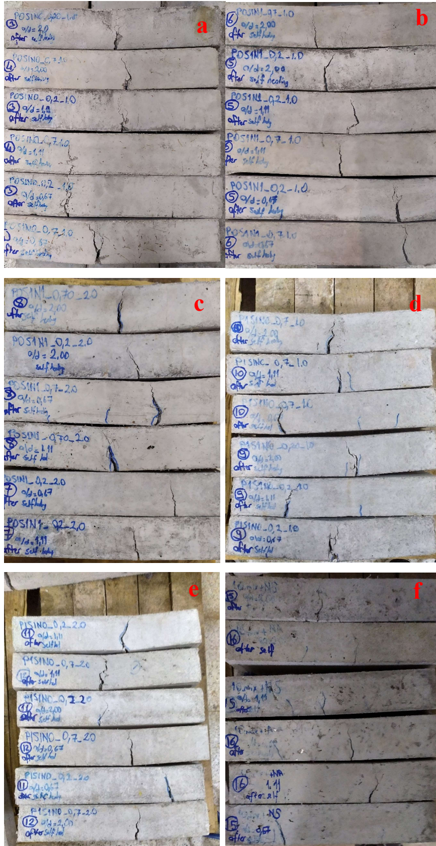
Resim 4.17. Kendiliğinden iyileşme sonrası küçük kırışların kırılma görüntüleri a) 3 ve 4. seri b) 5 ve 6. seri c) 7 ve 8. seri d) 9 ve 10. seri e) 11 ve 12. seri f) 15 ve 16. seri
