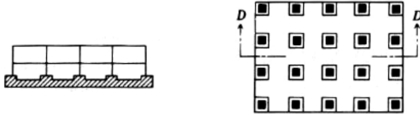
Şekil 3.8. Düz kirişli radye jeneral temel D-D kesiti
