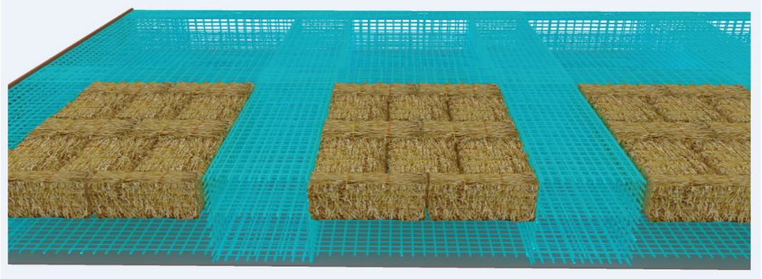
Şekil 4.16. Kirişli radye temel sisteminde dolgu malzemesinin kullanılması
