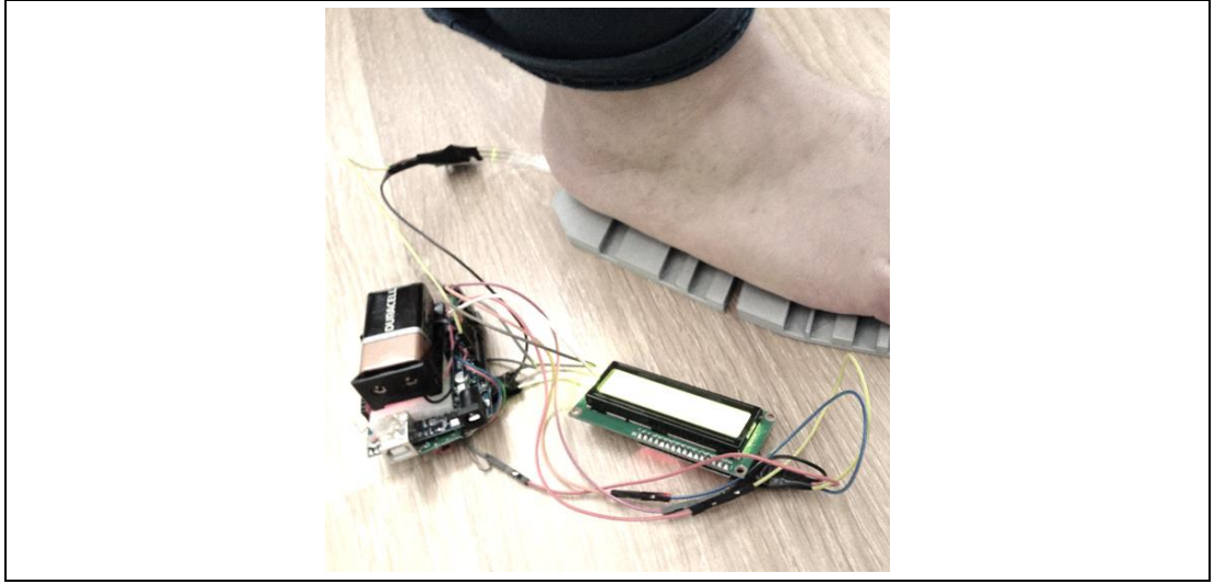
Fotoğraf 3.3. Basınç ölçüm düzeneği
