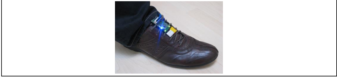
Fotoğraf 2.1. Mikrodenetleyici kartın yerleşimi [24]
