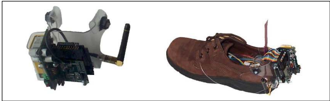
Şekil 2.11. Elektronik düzenek ve sensörlerin montaj şekli [25]
