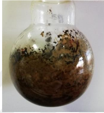
Şekil 5.19. 24 saat 105 °C’de vakum ortamında manyetik karıştırıcıda karıştırıldıktan sonra gözlenen kahve rengi sarı renkli ürün (R3)
