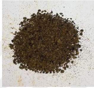
Şekil 5.65. 105 °C'de Etüvde kurutulan R5 aşı kopolimeri
