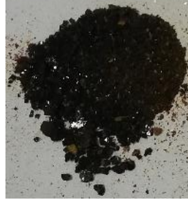
Şekil 7.13. 105 °C’de Etüvde kurutulan koloidal çökelti (U2B)
