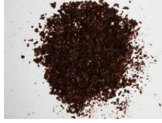
Şekil 6.14. 105 °C'de Etüvde kurutululan K3 aşı kopolimeri
