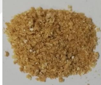
Şekil 6.10. 105 °C'de Etüvde kurutulan K2 aşısı kopolimeri
