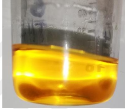
Şekil 7.3. THF ile çözünen, süzgeç kağıdı ile süzülüp behere alınan kısım (G1)
