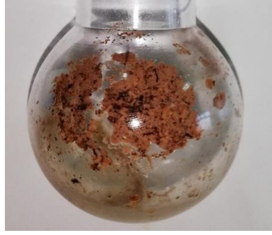
Şekil 7.29. Vakum ortamında 120 °C’de manyetik karıştırıcıda karıştırıldıktan sonra gözlenen koyu kahve renkli ürün (G2)
