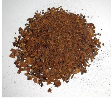
Şekil 5.32. 105 °C’de etüvde kurutulan santrifüj sonunda dibe çöken kısım (R4A)
