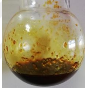
Şekil 5.15. 24 saat 105 °C de vakum ortamında manyetik karıştırıcıda karıştırıldıktan sonra gözlenen koyu kahve-sarı renkli ürün (R2)
