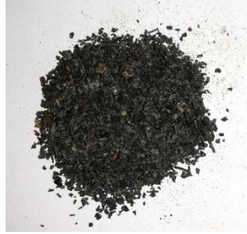
Şekil 5.20. 105 °C’de etüvde kurutulan ve santrifüj ile dibe çöken kısım (R3A)
