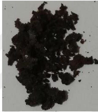
Şekil 7.30. Etüvde 105 °C’de kurutulan G2 aşı kopolimeri
