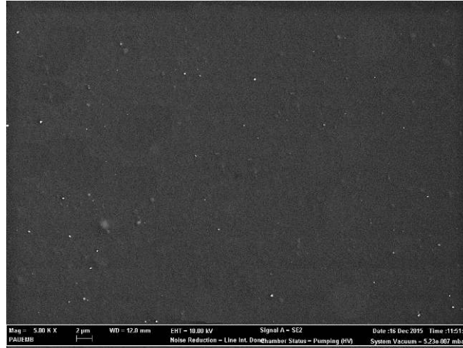
Şekil 6.9 ITO kaplı cam elektrot yüzeyinde CH için SEM görüntüsü (5000 x)
