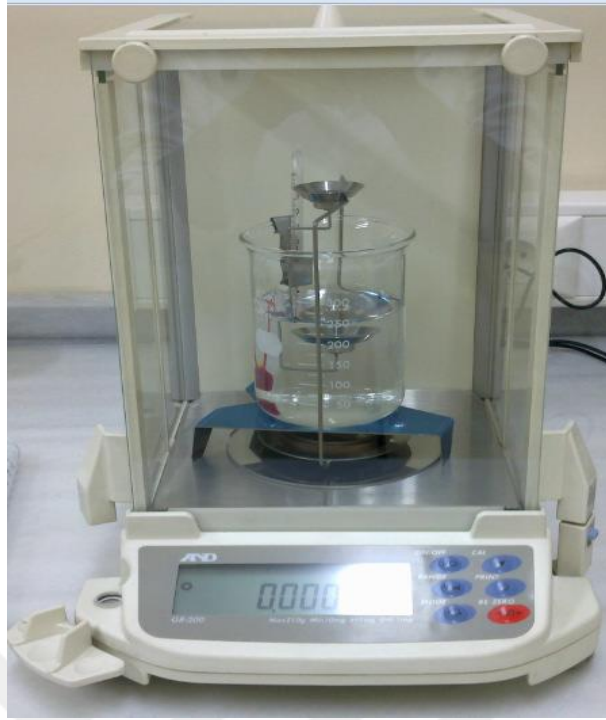
Şekil 3.13. And/gr 200 yoğunluk testi cihazı
