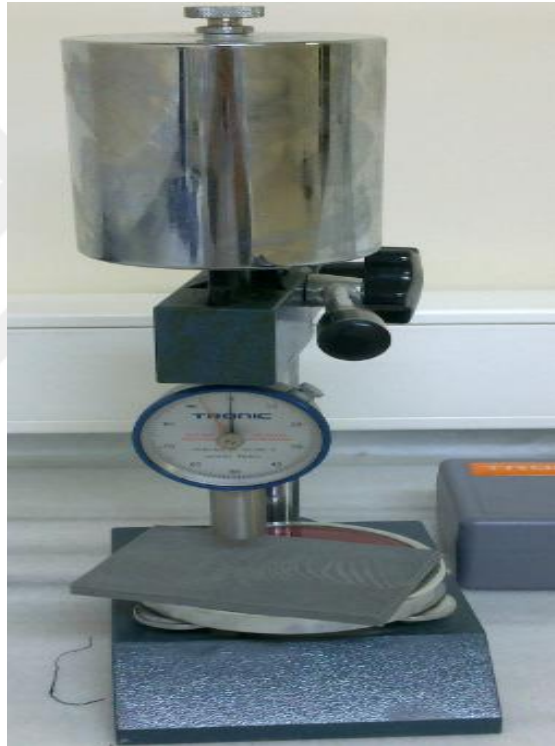
Şekil 3.11. Tronic shore A-D sertlik ölçme test cihazı
