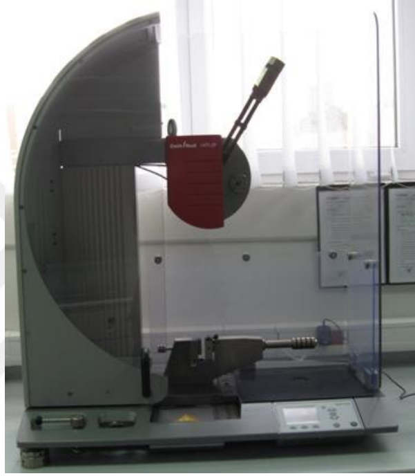
Şekil 3.9. Zwick-Roell Hit 5,5 P darbe dayanımı test cihazı
