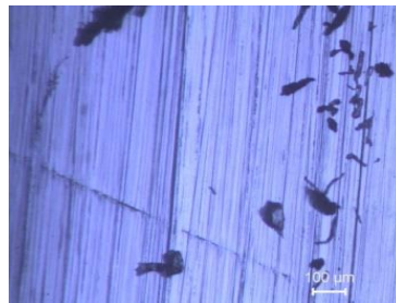
Şekil 4.40. Çelik diskin PP polimeri ile sürtünme yüzeyinin SEM görüntüsü
