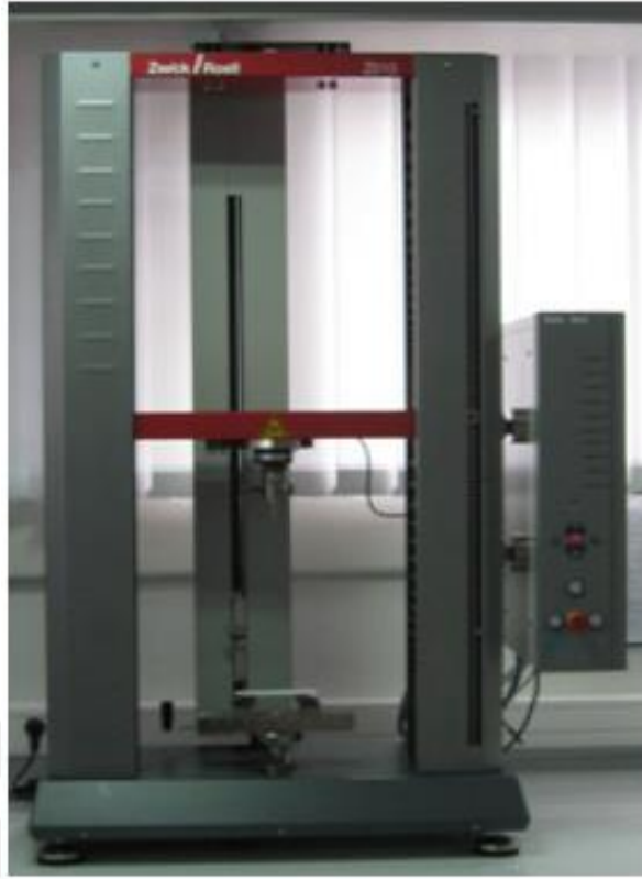
Şekil 3.7. Zwick-Roell çekme-eğilme testi cihazı
