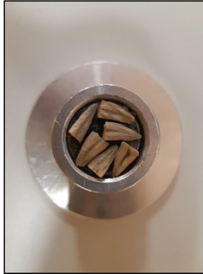
Resim 13. Platin kaplanmış ve SEM’de görüntülenmeye hazır diş örnekleri
