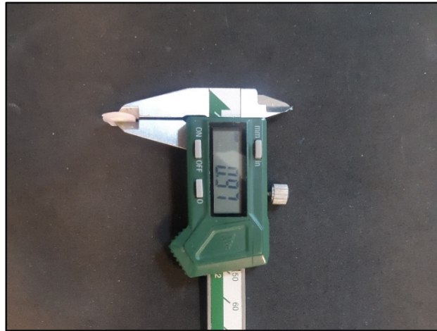
Resim 5. Kesitlerin kalınlıklarının dijital kumpas ile kontrol edilmesi
