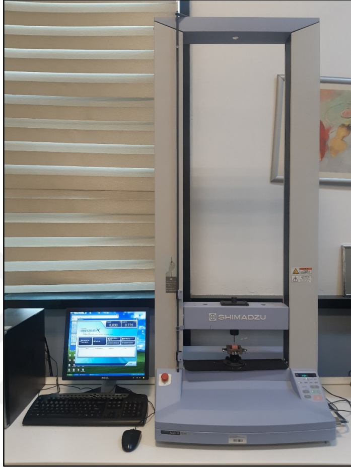
Resim 9. Push-out bağlanma dayanımı testi yapılan universal test cihazı
