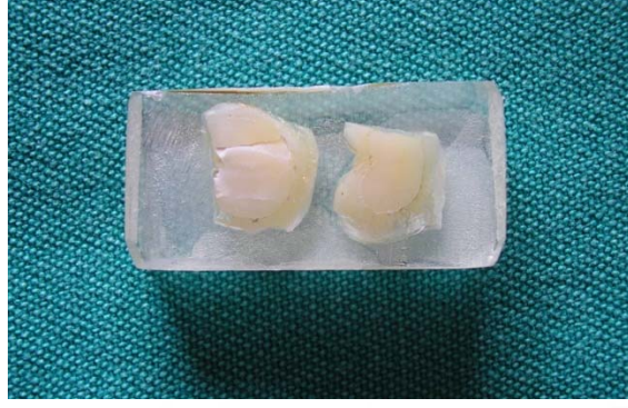
Resim 9: Fırçalanmış Demineralize ve Sağlam Mine Örnek Çifti
