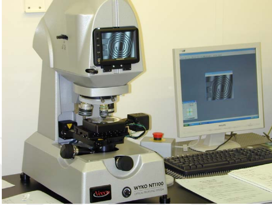
Resim 10. Optik Profilometre Cihazı (Wyko NT1100)
