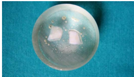
Resim 4: Rezin Bloğa Gömülü Mine Çifti Örneğinin Üstten Görünüşü
