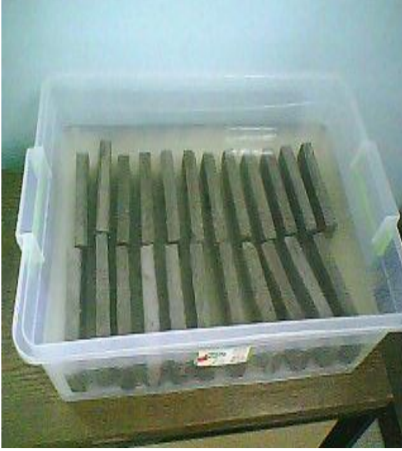
Şekil 5.9. Su emme, kuruma deneyi kabı ve tartı aleti
