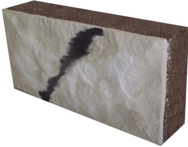
Şekil 5.11. Boya işlemeine tabi tutulmuş ve dekoratif amaçlı kaplama yapılmış numuneler
