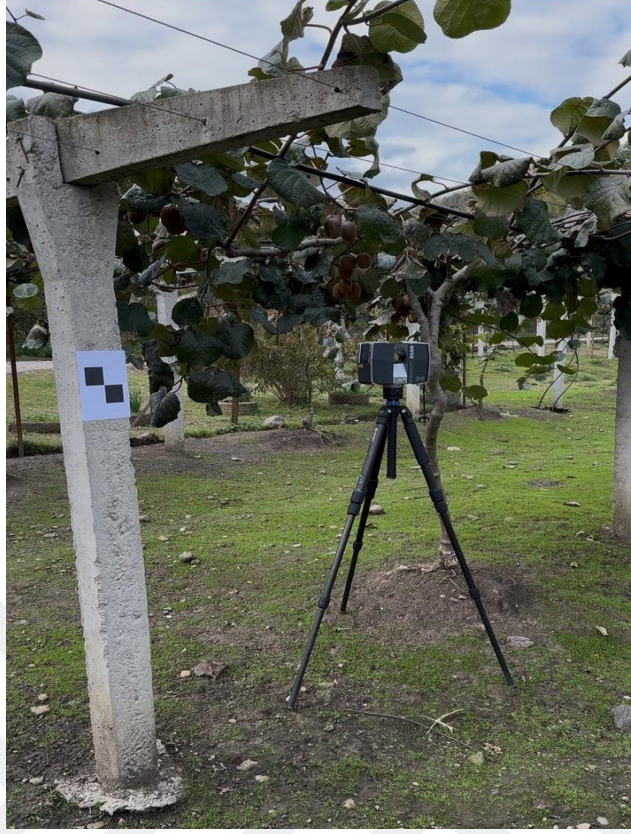
Şekil 12. Çalışmada kullanılan yersel lazer tarayıcı ve hedef noktası
